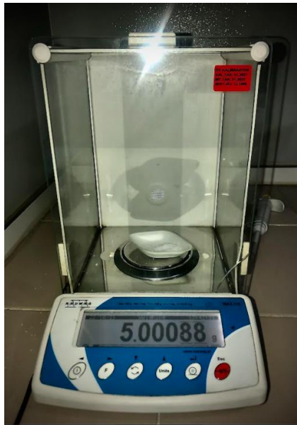
Şekil 12: Hassas tartıda sitrik asit ölçümü
