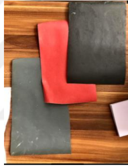
Şekil 6: Kesitleri alındıktan sonra dişlerin zımparalanmasında kullanılan zımpara kağıtları (800, 1000, 1200 gren)
