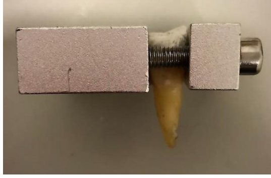
Şekil 3: Kesiti alınacak dişin isomet cihazına yerleştirilmeden önce sabitlenmesi
