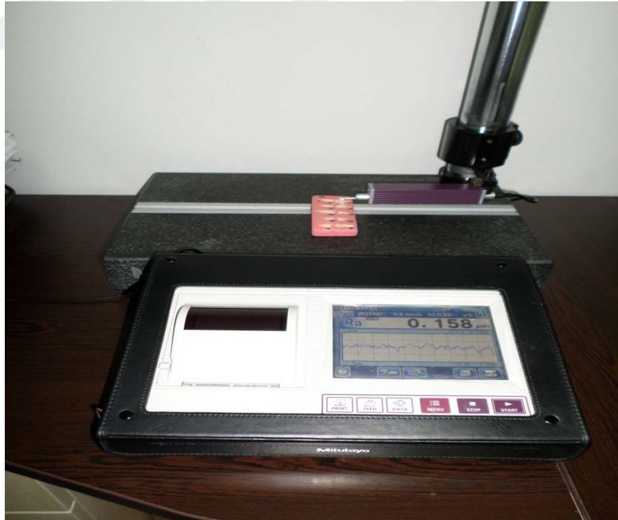
Resim 8: Yüzey pürüzlülüğü testi cihazının görüntüsü
