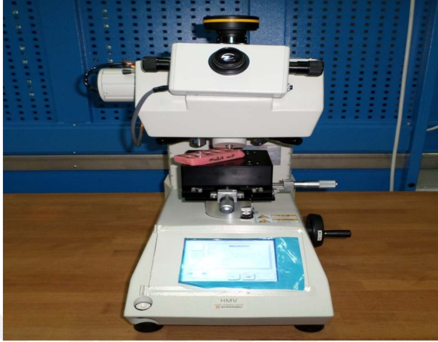
Resim 7: Vickers mikrosertlik testi cihazının görüntüsü
