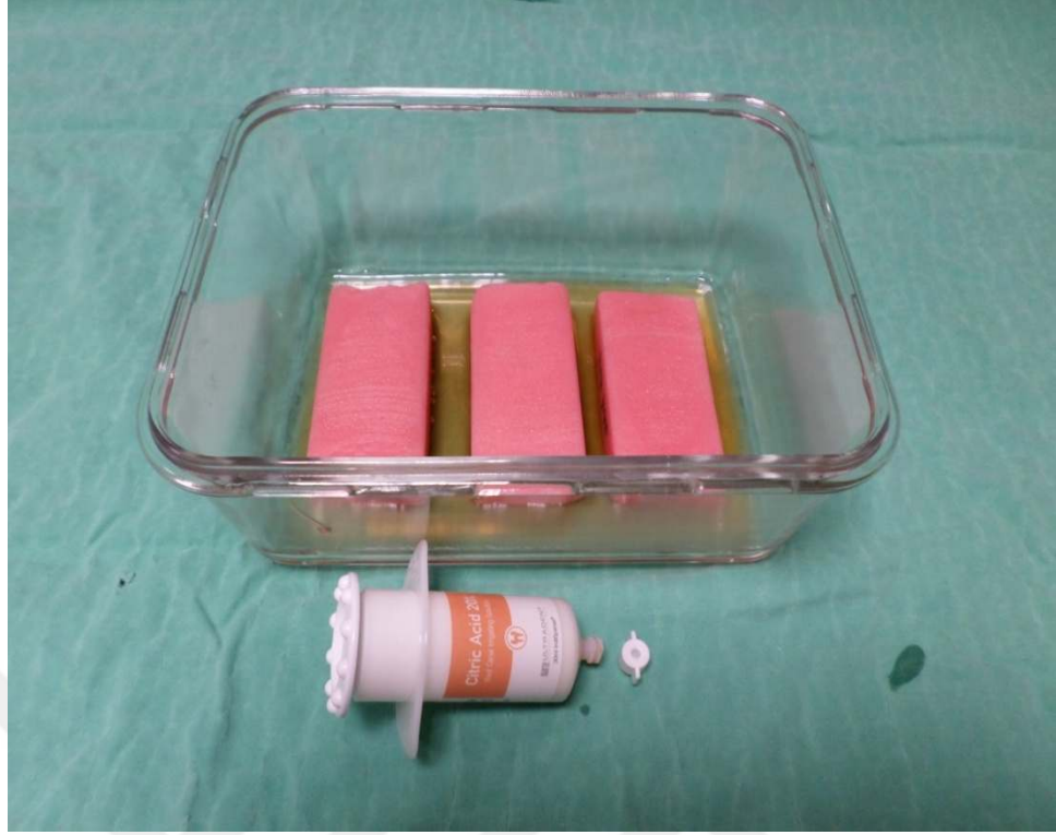
Resim 5: %20'lik sitrik asit ile şelasyon işleminin görüntüsü
