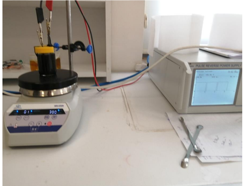
Şekil 4.15. Pulse cihazına bağlı B_4C kaplama ünitesi
