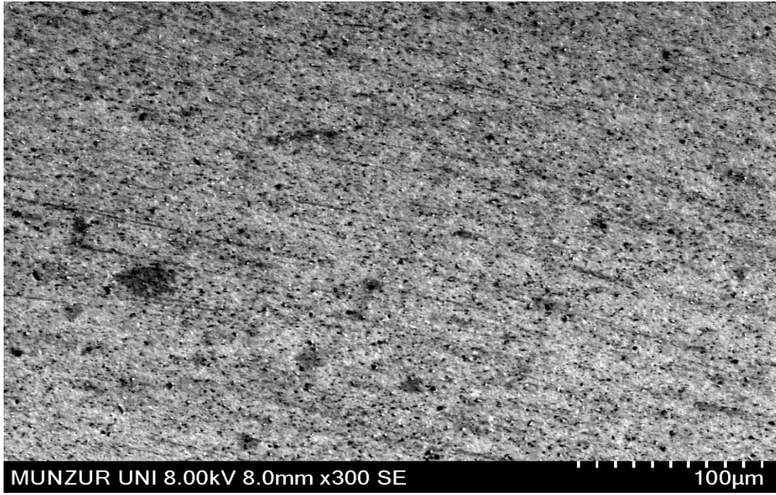
Şekil 5.9. B_4C ile kaplı numunenin x300 büyütmedeki SEM görüntüsü
