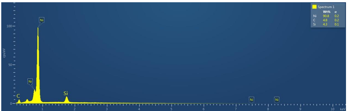
Şekil 5.16. SiC kaplı numunenin EDS analizi
