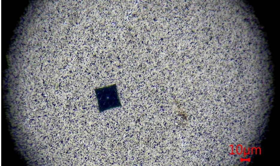
Şekil 5.25. SiC kaplı numune üzerine yapılan sertlik ölçüm deneyi
