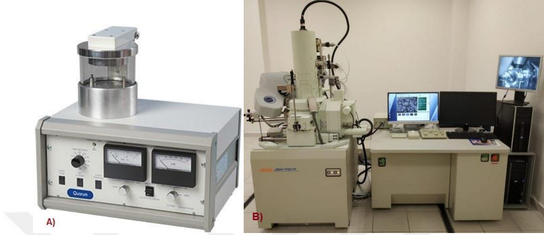
Şekil 3. 11. A) Altın kaplama cihazı B) Taramalı Elektron Mikroskobu
