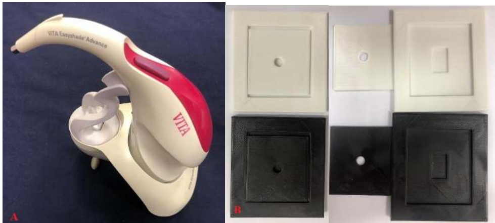
Şekil 3. 10. A) Spektrofotometre B) Özel yapılmış renk ölçüm apareyleri
