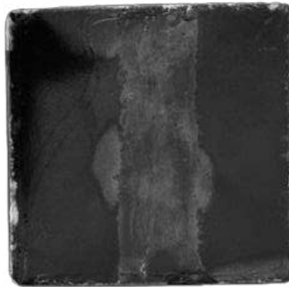
Şekil 9.15. 550 °C 180 dakika %100 talk uygulanmış parça görseli
