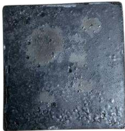
Şekil 9.26. 600 °C 120 dakika %100 talk uygulanmış parça görseli
