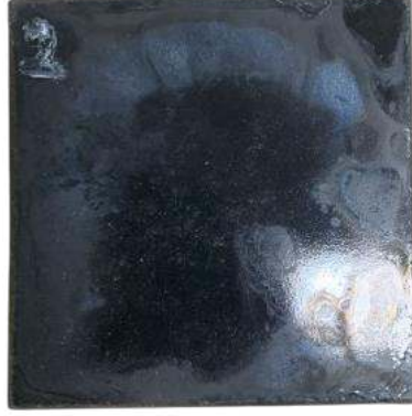
Şekil 9.10. 550 °C 60 dakika %100 talk uygulanmış parça görseli
