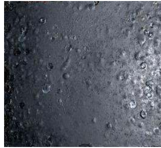
Şekil 9.28. 600 °C 180 dakika %100 talk uygulanmış başarılı homojen parça görseli
