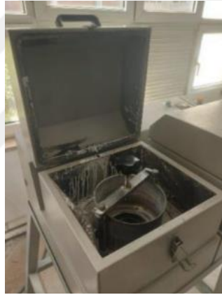
Şekil 7.4. Öğütme işlemi için kullanılan jet mil
