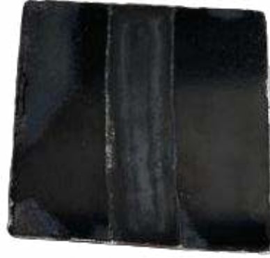
Şekil 9.12. 550 °C 120 dakika %100 talk uygulanmış parça görseli
