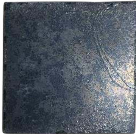
Şekil 9.24. 600 °C 60 dakika %100 talk uygulanmış parça görseli
