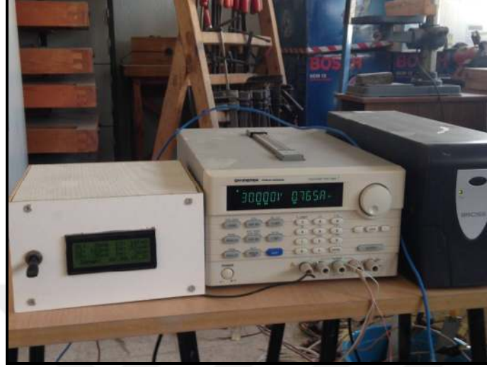
Resim 3.11 Numuneler üzerinden geçen akımları ölçen devre.
