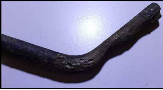
Resim 4.2 Beton içerisinden çıkartılan donatıların beton ve pasdan temizlenmesi.
