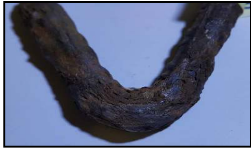
Resim 4.2 Beton içerisinden çıkartılan donatıların beton ve pasdan temizlenmesi.
