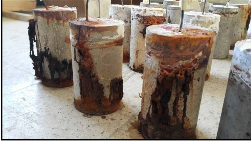
Resim 4.1 Hızlandırılmış korozyon deneyi sonrası bir numune.
