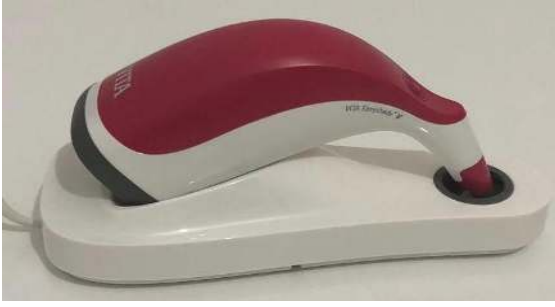
Resim 8. Çalışmada kullanılan spektrofometre cihazı
