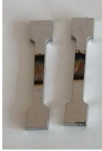
Şekil 4.4. Kaynaklı çekme numuneleri
