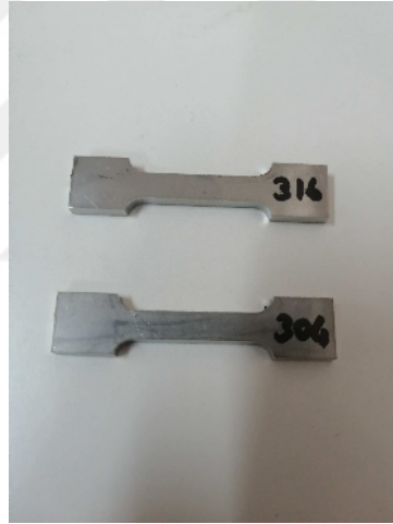
Şekil 4.5. Kaynaksız çekme numuneleri
