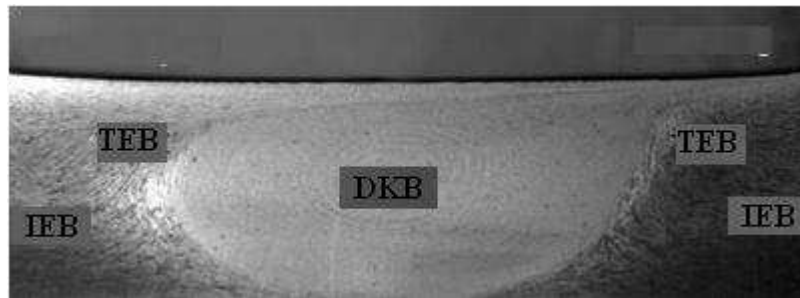
Şekil 2.9. 7075 Al-T651'deki (standart dişli pim, 400 dev/dak ve 51 mm/dak) makro yapısal bölgeler [73]
