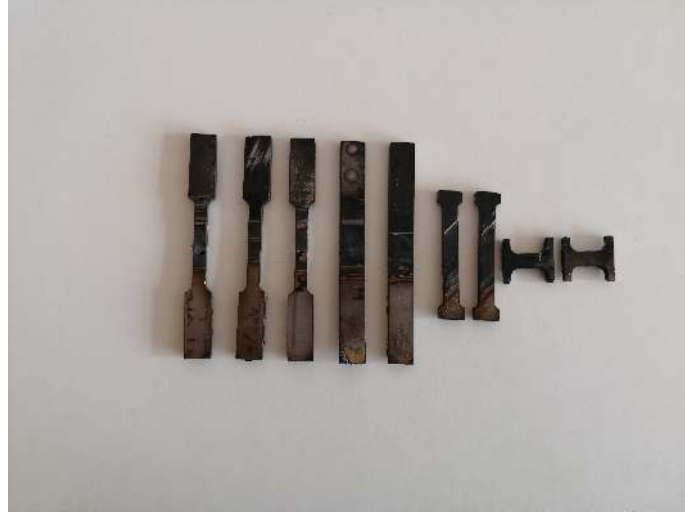
Şekil 4.10. Kaynaklanmış paslanmaz çelik-karbonlu çelik çiftinin deney numuneleri
