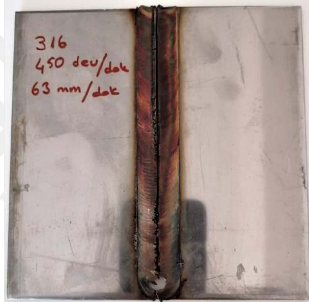
Şekil 4.1. Devir sayısı 450 dev/dak, ilerleme hızı 63 mm/dak ile kaynaklanan malzeme
