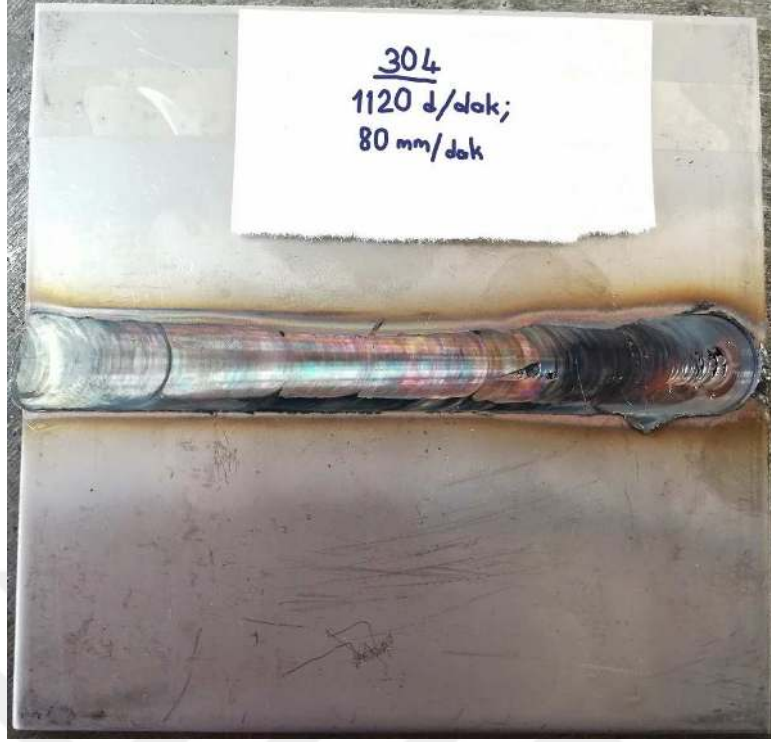
Şekil 4.3. Sürtünme karıştırma kaynağı ile birleştirilen östenitik paslanmaz çelik
