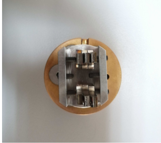
Őekil 4.26. Kırık yzeylerin numune platformuna yerleřtirilmesi
