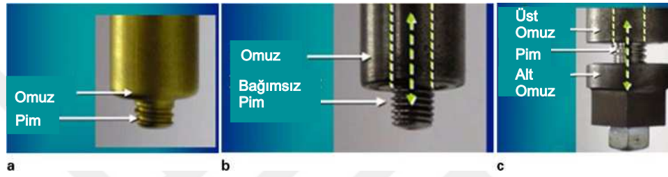
Şekil 2.6. Karıştırıcı takım tipleri a) sabit pim, b) ayarlanabilir pim, c) makara tipi pim [34]
