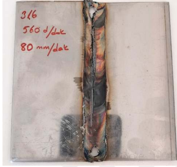
Şekil 4.2. Devir sayısı 560 dev/dak, ilerleme hızı 80 mm/dak ile kaynaklanan malzeme
