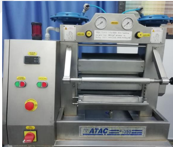
Şekil 2.3 Laboratuvar tipi fulard (Kişisel arşiv, 2020)
