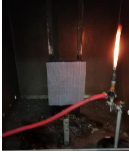
Şekil 2.8 Dikey güç tutuşurluk test cihazı (Kişisel arşiv, 2020)
