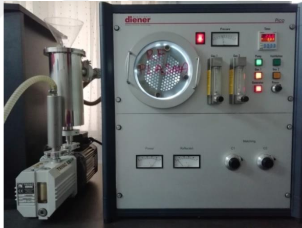
Şekil 2.2 Diener Pico-RF plazma cihazı (Kişisel arşiv, 2020)
