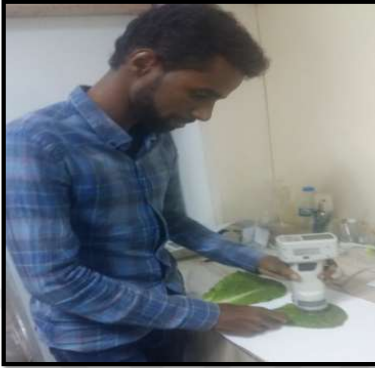
Şekil 3.15. Marul yapraklarında renk ölçümü
