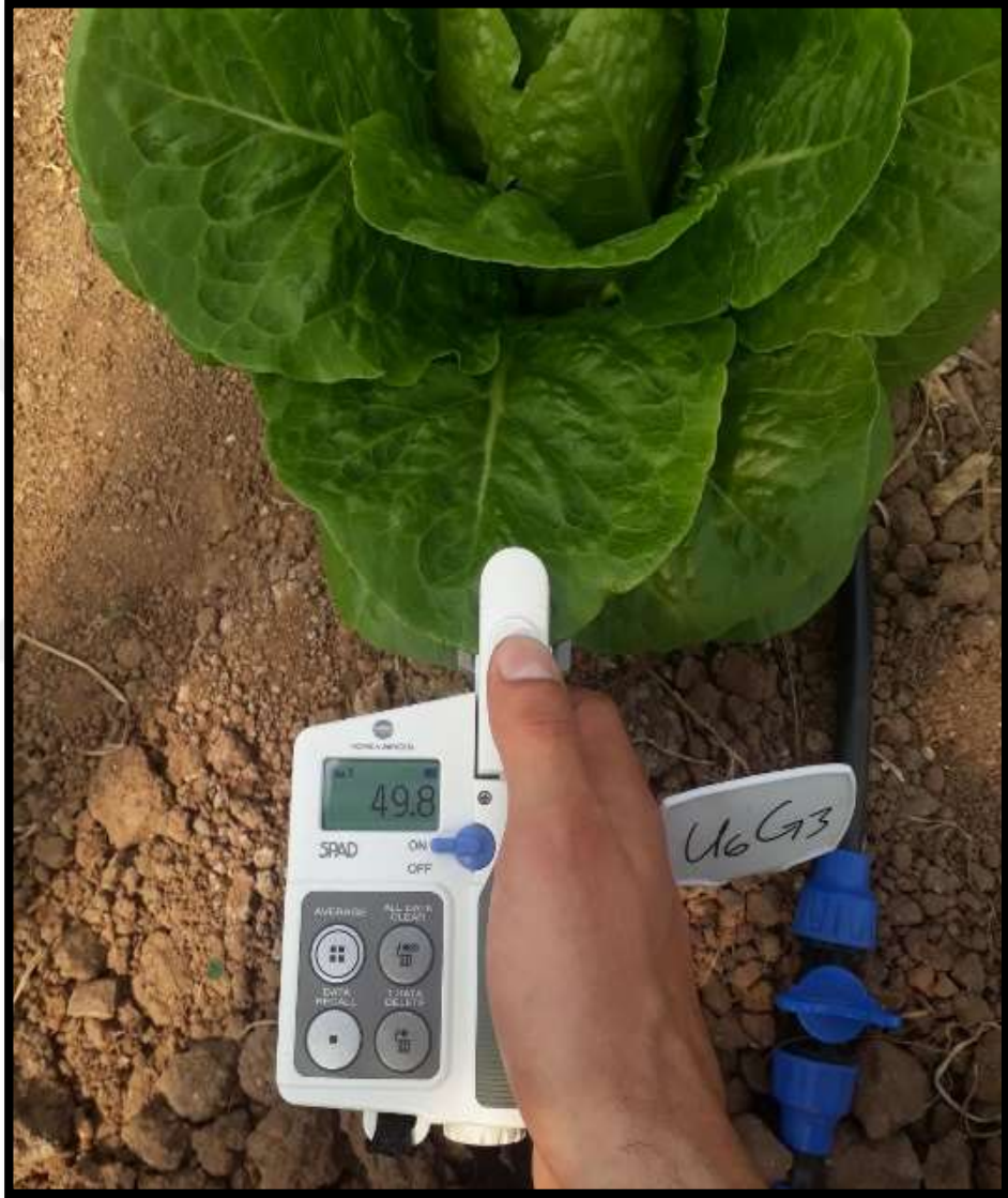
Şekil 3. 9. Bitkilerde SPAD500 cihazıyla klorofil ölçümü
