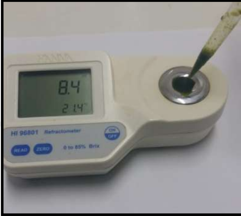
Şekil 3. 14. Dijital refraktometre ile SÇKM miktarı ölçümü
