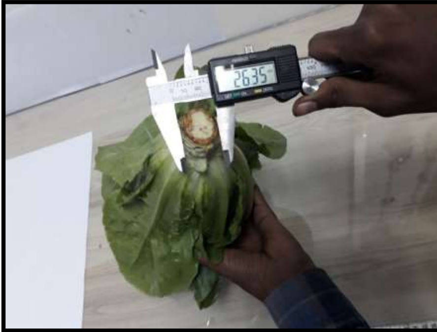
Şekil 3.11. Dijital kumpas ile kök boğazı çapının ölçülmesi
