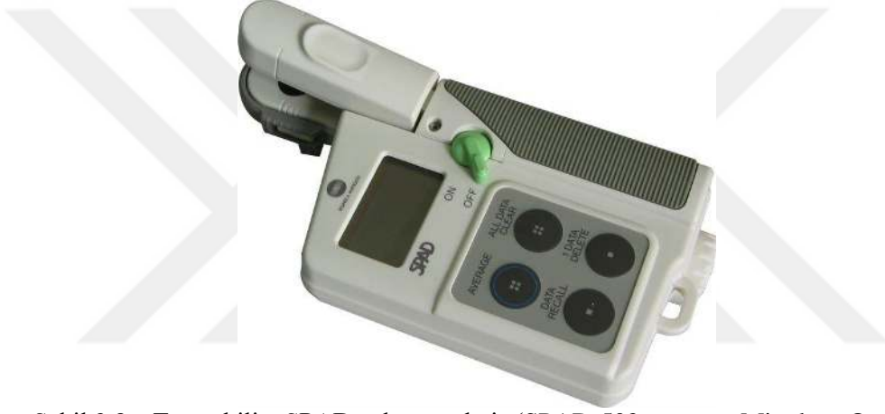
Şekil 3.8. Taşınabilir SPAD ölçüm aleti (SPAD-502 metre, Minolta, Osaka, Japonya)
