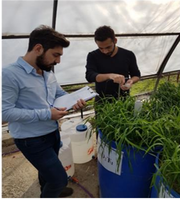
Şekil 3.18. Portatif EC metre ile derinlik boyunca toprak tuzluluğunun ölçülmesi
