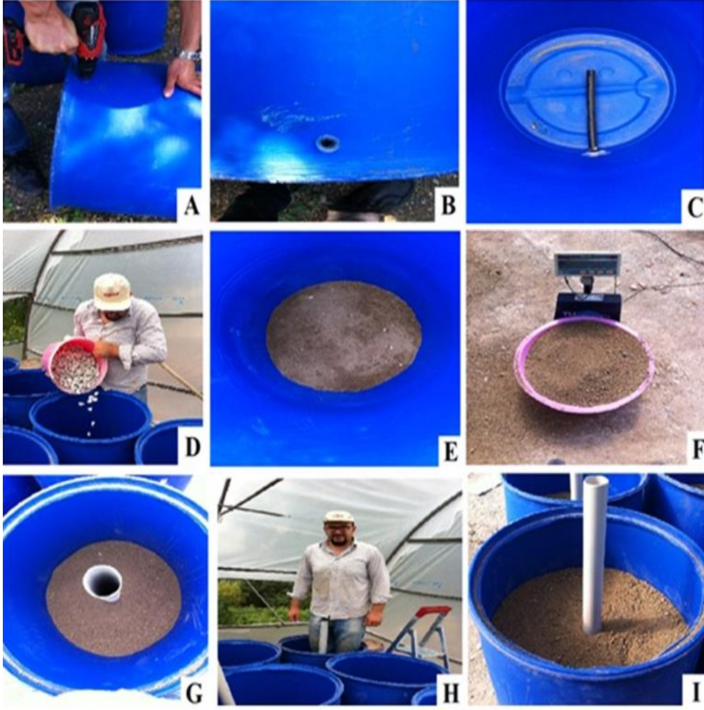
Şekil 3.5. Lizimetrelerin hazırlanması (A: Mariotte tüpünün lizimetreye bağlanması, B: Conta takılması, C: Lizimetrenin su giriş borusu, D: Lizimetrelerin tabanının çakıl ile doldurulması, E: Lizimetrelerin tabanına kum konulması, F: Toprakların tartılma işlemi, G: Lizimetrelere toprak konulması, H: Toprağın sıkıştırılması, I: Lizimetrelerin toprak ile doldurulması
