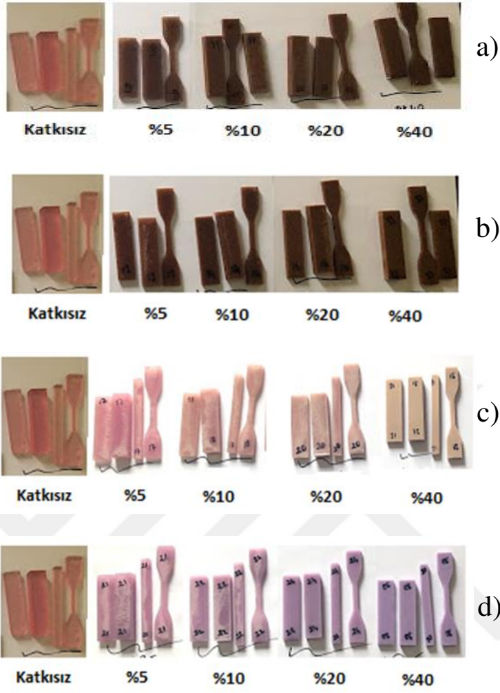
Şekil 4.3. a) Kayısı çekirdeği kabuğu b) Şeftali çekirdeği kabuğu c) Mermer tozu d) Boraks katkılı kompozit malzeme numuneleri
