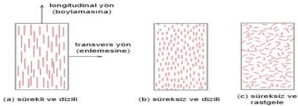
Şekil 2.9. Sürekli ve süreksiz fiber takviyeli kompozitler(Beşergil,2016)
