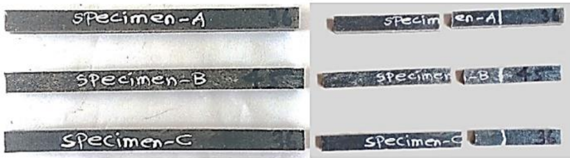
Şekil 1.7. Yer fıstığı kabuğu ve nano alümina katkılı yüksek yoğunluklu polietilen kompozitler [45]
