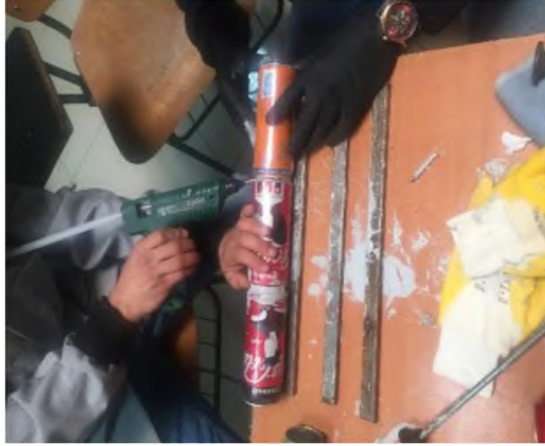
Şekil 5.9. Kola kutularının silikon ile birleşimi yapılırken
