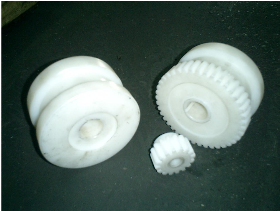
Şekil 4.14 PA6 malzemeden imal edilen pinyon ve araba tekerlekleri
