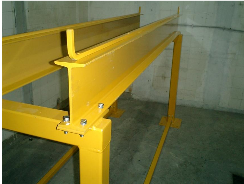
Şekil 4.16 Kren köprüsü montajı gerçekleştirilmiş şekilde genel görünüşü
