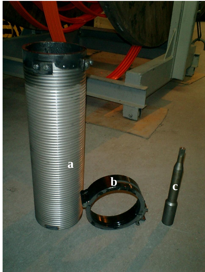
Şekil 4.9 AISI1040 çeliğinden imalatı yapılan tanbur (a), halat kalvuzu (b) ve tahrik mili (c)
