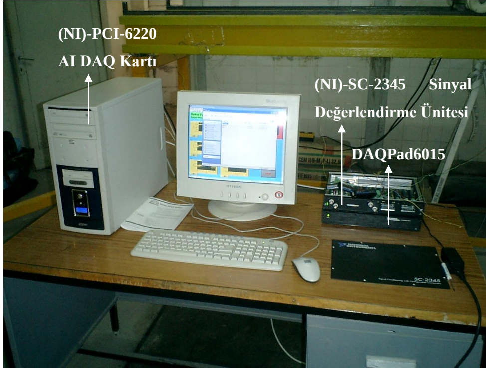
Şekil 5.14 Deneysel analizler için hazırlanmış ölçüm cihazları
