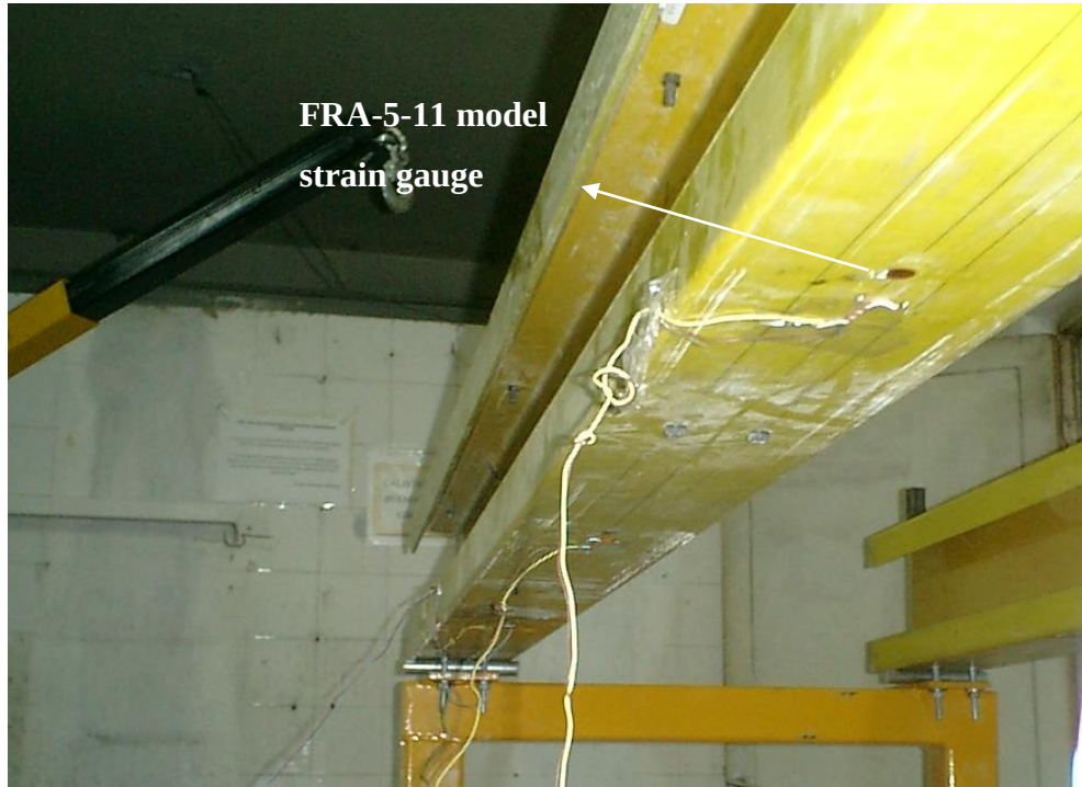
Şekil 5.12 Analizlerde kullanılan FRA-5-11 model strain gauge'ler
