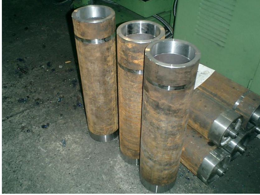
Şekil 4.8 Tanbur gövdelerinin imalat öncesi kılavuzları açılmış
