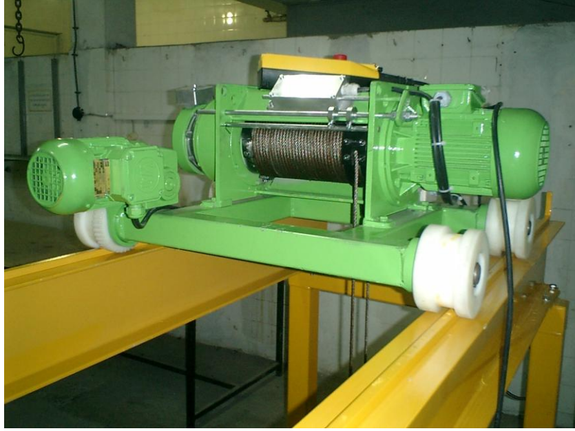
Şekil 4.17 Köprü montajı gerçekleştirildikten sonra kirişler üzerine oturtulmuş araba genel görüntüsü
