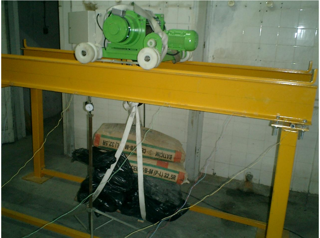
Şekil 5.106 Maksimum sehimin oluştuğu noktada yapılan sehim ölçümü
