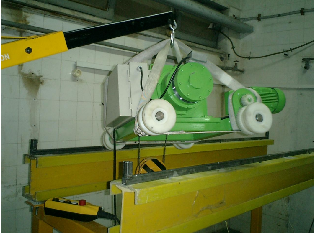
Şekil 5.105 Köprü kirişleri üzerinde yükleme yokken kompratör sıfırlanır
