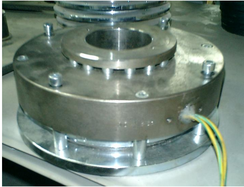
Şekil 4.13 Fren sistemi montajı yapılmış hali
