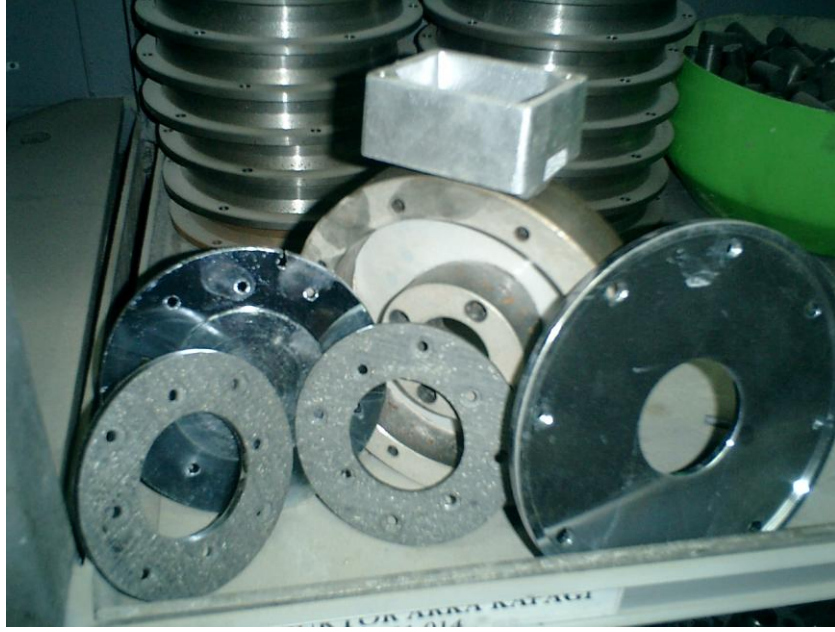
Şekil 4.12 Fren sistemini meydana getiren fren diskleri ve gövdesi
