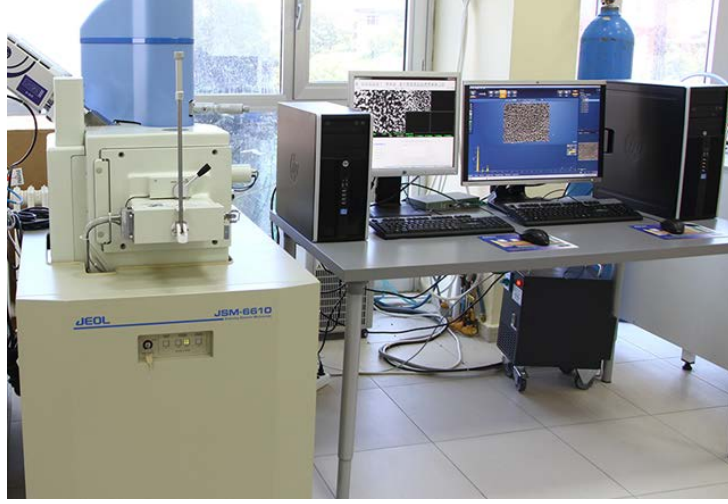
Şekil 3.28. Yüzey topografisinin incelenmesinde kullanılan taramalı elektron mikroskobu
