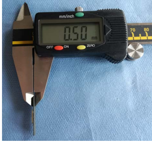
Şekil 3.16. Örnek kalınlığının ölçülmesi
