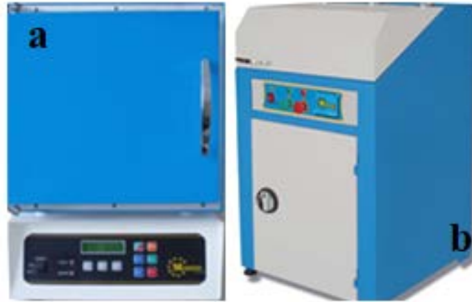
Şekil 3.3. Döküm işleminde kullanılan manşet fırını (a) ve santrifüj cihazı (b)
