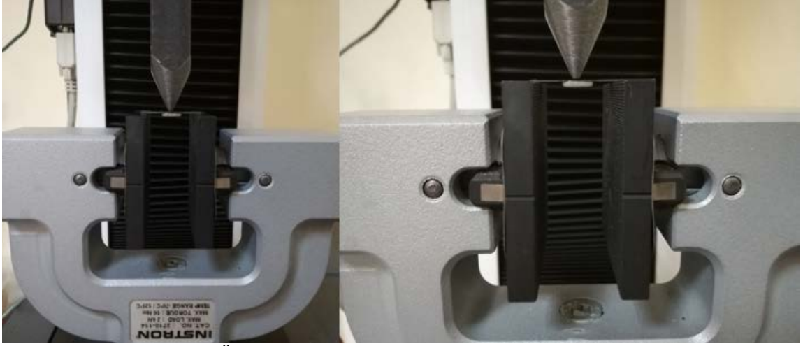
Şekil 3.26. Üç nokta eğme testi için hazırlanan test düzeneği
