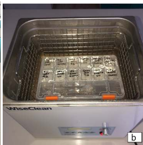
Şekil 3.5 a, b: Örneklerin Ultrasonik Temizleyicide Temzilenmesi
