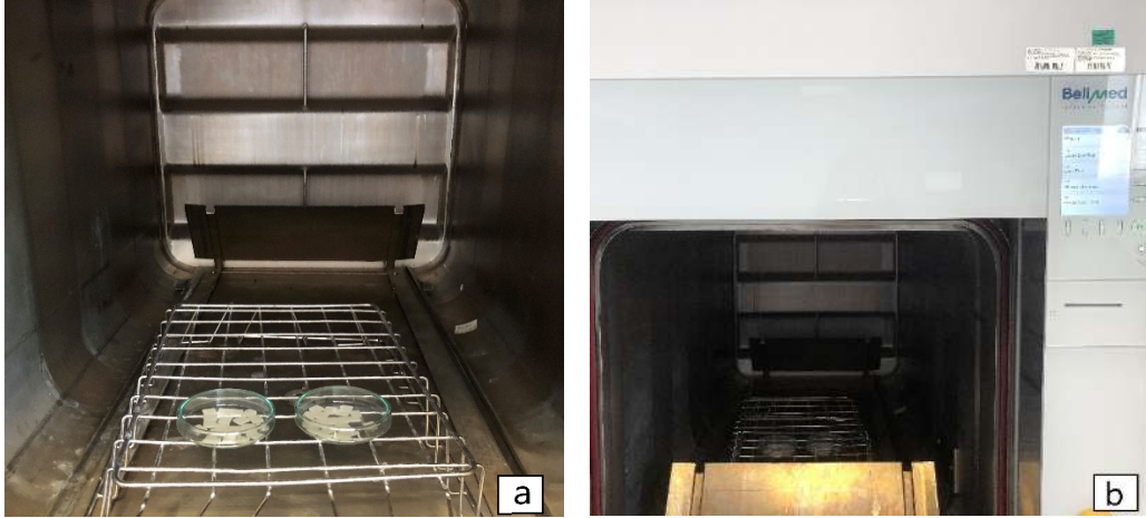
Şekil 3.17 a, b: Örneklerin cam petri kaplarında otoklava yerleştirilmesi
