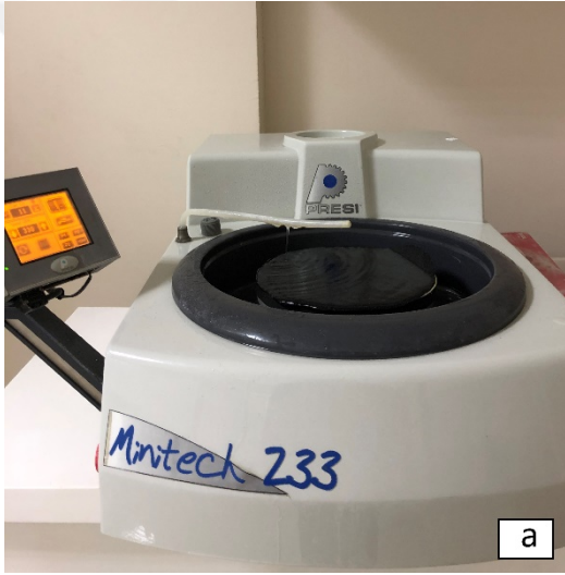
Şekil 3.4 a: Yüzey standardizasyonu için kullanılan Minitech 233 b: Örnek kalınlıklarının kontrol edilmesi
