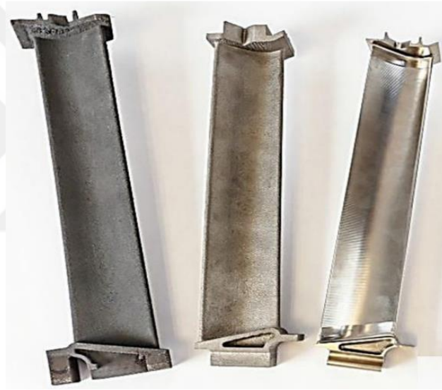
Şekil 1.19. EB-PBF ile üretilmiş TiAl türbin bıçakları [54]
