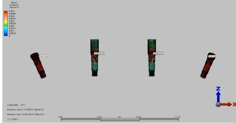
Resim 63. PEEK altyapı için vida çevresinde görülen Von Mises stresleri
