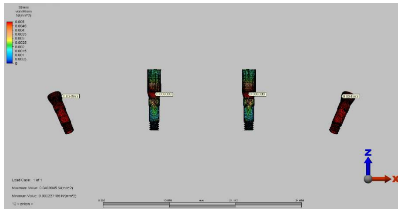
Resim 62. Zirkon altyapı için vida çevresinde görülen Von Mises stresleri
