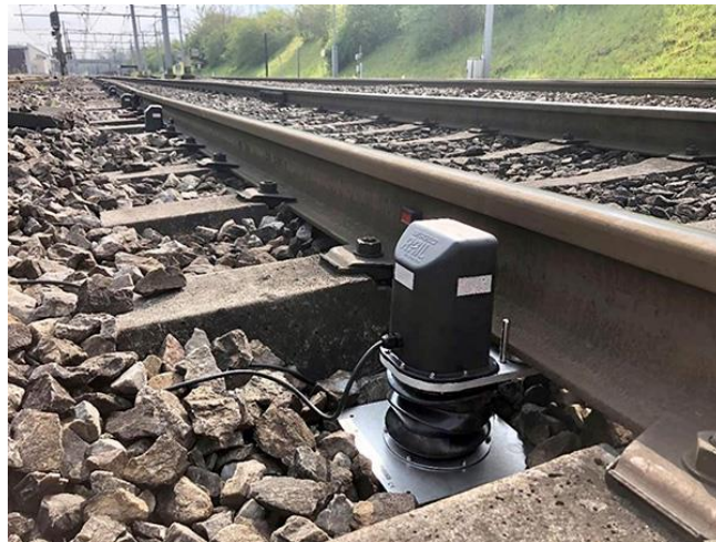
Görsel 20.1.1.1. Ray deformasyon sensörü (ENSCO Rail 2022)
