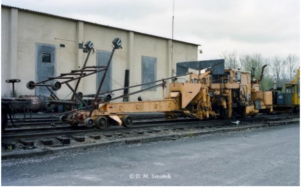
Görsel 19.1.1.1. Balast sıkıştırma makinesi (Plasser & Theurer 2022)
