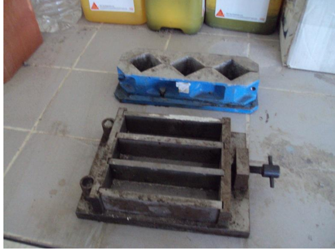
Şekil 2.1 Standart küp ve prizma kalıplar
