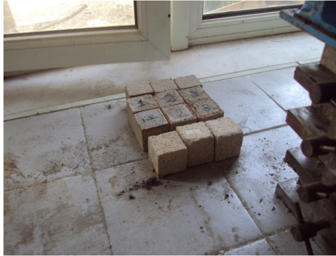
Şekil 2.12 Hidroklorik asite maruz kalan deney örnekleri
