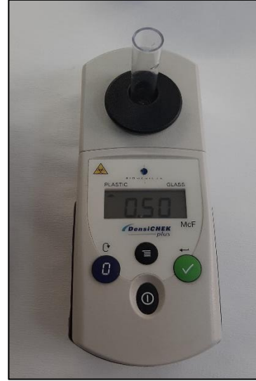
Şekil 11: DensiCHEK plus (Mikroorganizma süspansiyonlarının optik yoğunluğunu ölçmede kullanılan cihaz)
