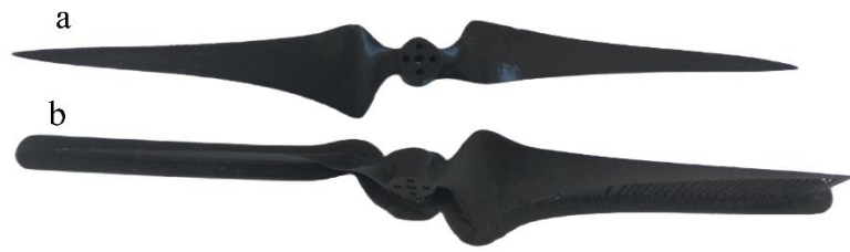
Şekil 4.15. Yazıcıdan üretilen pervanelerin görünümü
