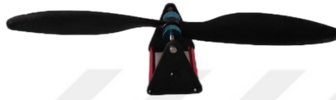
Şekil 3.13. Çalışmada kullanılan pervane balans düzeneği
