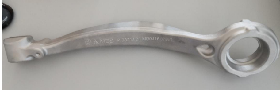
Şekil 6.6 Sıcak dövme sonrası elde edilen ham salıncak kolu gövdesi (Kişisel arşiv, 2020)
