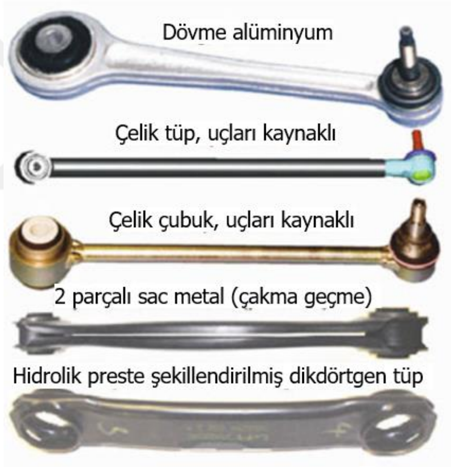
Şekil 2.4 Farklı üretim yöntemleri ile üretilmiş iki-noktalı salıncak kolları (Heiřing ve Ersoy, 2011)
