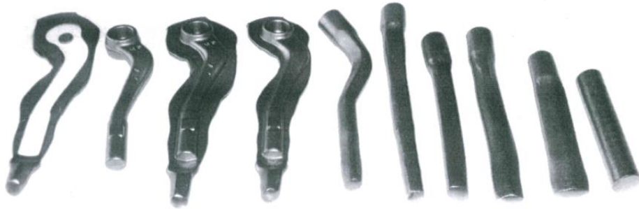
Şekil 6.5 Rot başı gövdesinin dövme aşamaları (HeiBing ve Ersoy, 2011)
