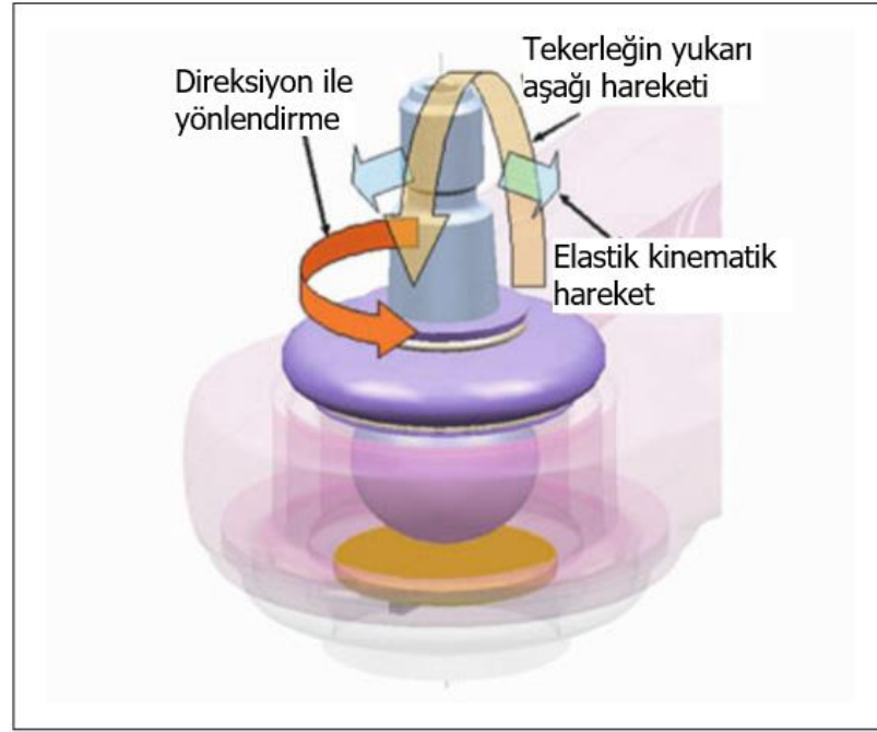
Şekil 2.6 Küresel yatak sisteminin serbestlik derecesi (Heißing ve Ersoy, 2011)
