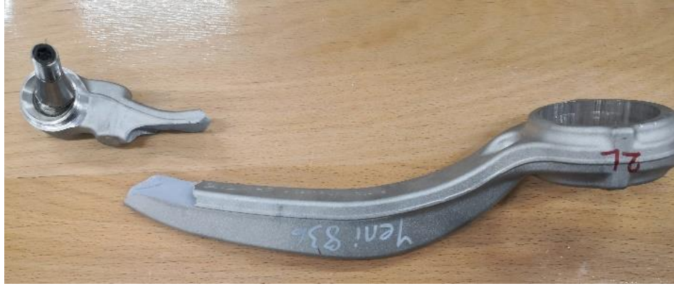
Şekil 6.21 Burkulma sonrası MMK malzemeli salıncak kolunda meydana gelen nihai hasar (ZF Friedrichshafen AG, 2020)
