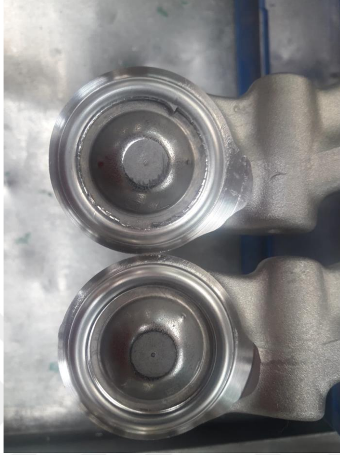
Şekil 6.14 Sıvama operasyonu sonrası sıvama bölgesinde çatlakları olan ve olmayan salıncak kolları (ZF Friedrichshafen AG, 2020)
