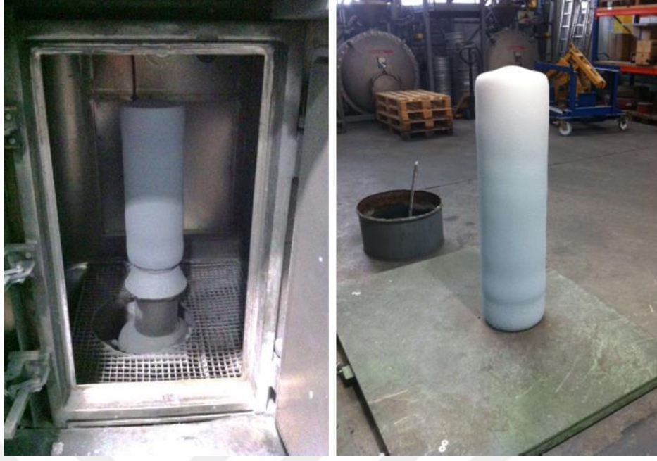
Şekil 6.2 Sprey döküm sonrası elde edilen ham kütük (Gustke, 2018)
