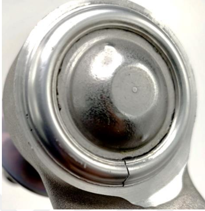
Şekil 6.18 %10 Si partikül katkılı MMK malzemeli salıncak koluna ait sıvama bölgesindeki yorulma hasarı (ZF Friedrichshafen AG, 2020)
