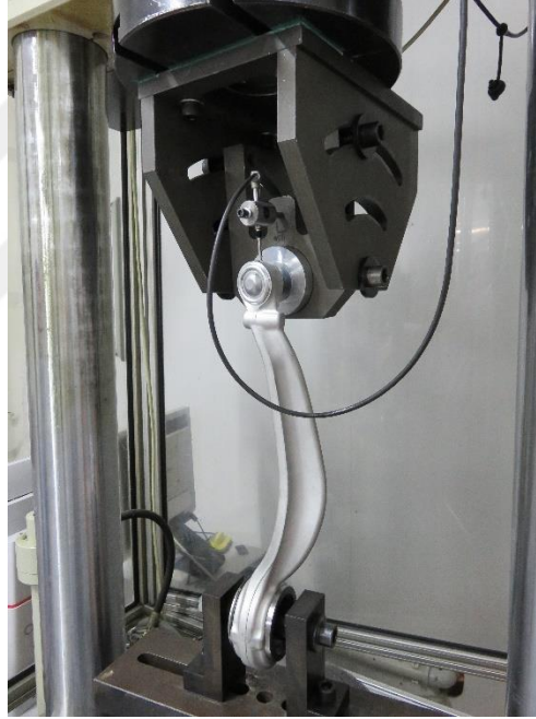
Şekil 6.20 Örnek burkulma testi düzeneği (ZF Friedrichshafen AG, 2020)
