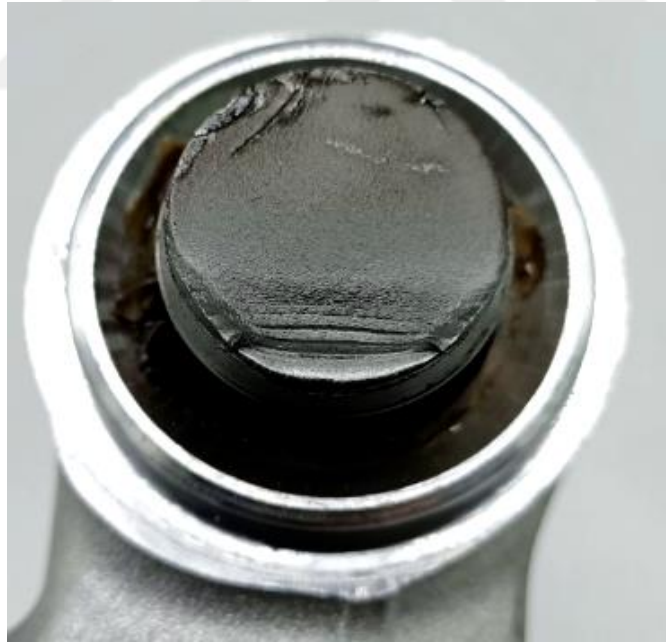
Şekil 6.19 Standart 6110 alaşımlı salıncak koluna ait mafsallı bölgedeki yorulma hasarı (ZF Friedrichshafen AG, 2020)
