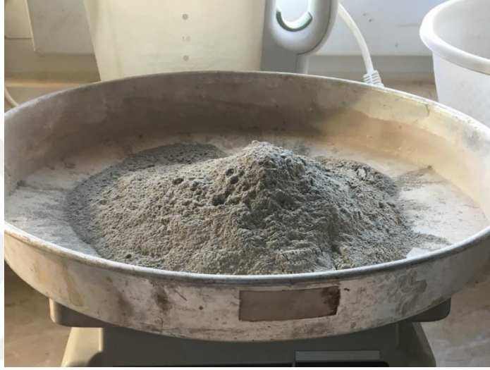
Görsel 2.1. Deneylerde kullanılan uçucu kül
