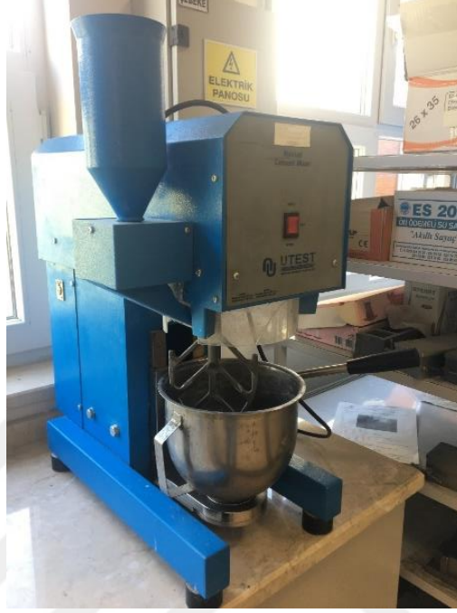
Görsel 2.10. UTEST marka 5 litre kapasiteli otomatik karıştırıcı
