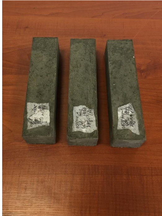
Grsel 2.20. 100 gram su ile hazırlanmıř genleřtirilmiř perit agregası ieren geopolimer har numuneleri
