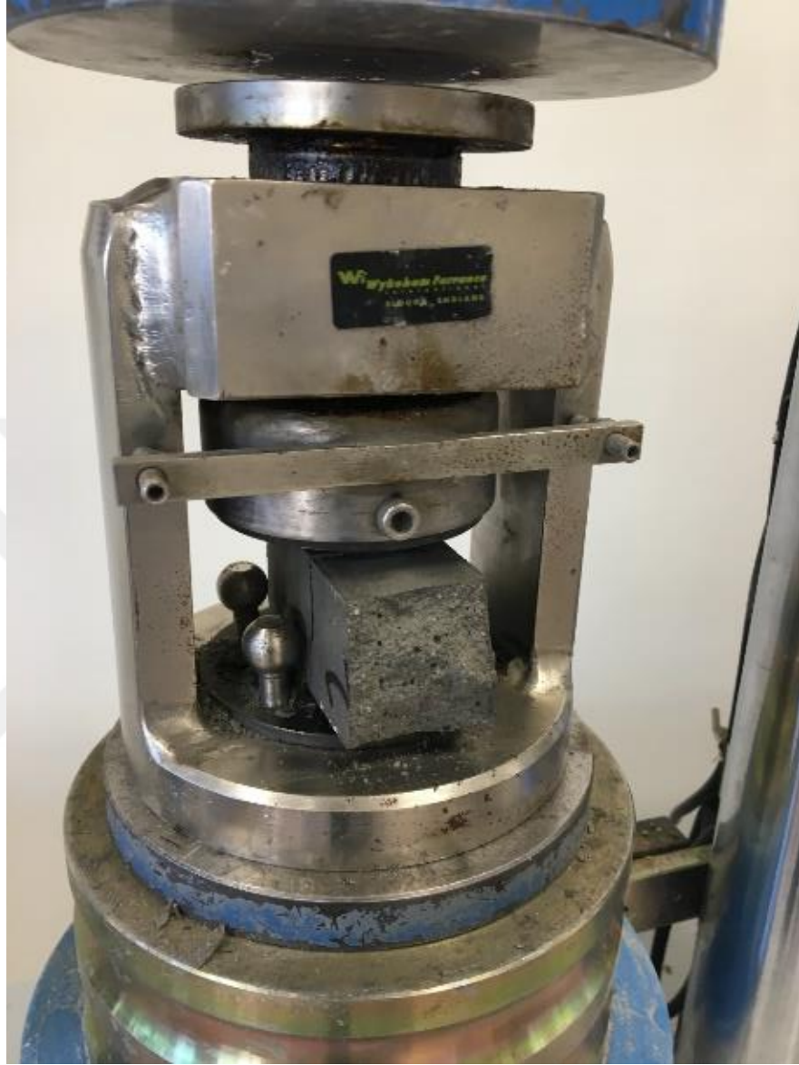
Grsel 2.22. Basın dayanım deneyi yapılması
