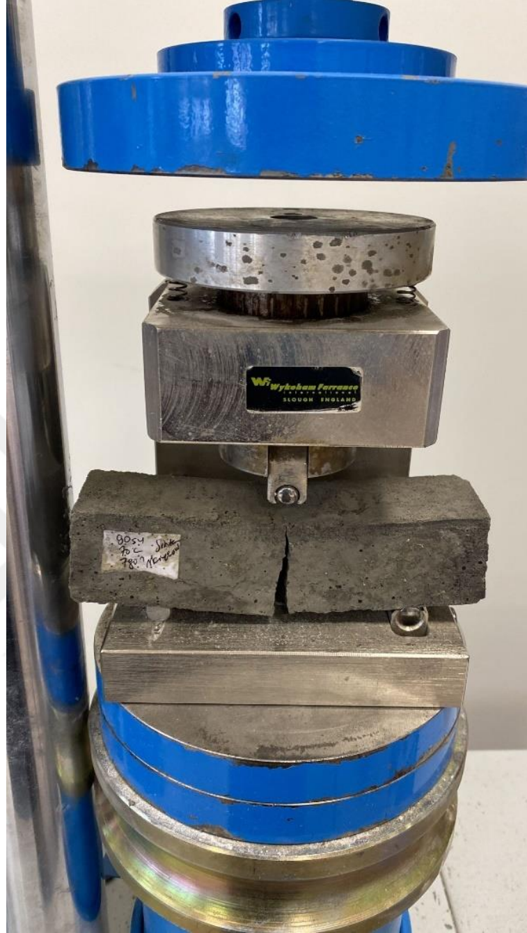
Görsel 2.21. Eğilme dayanım deneyi yapılması
