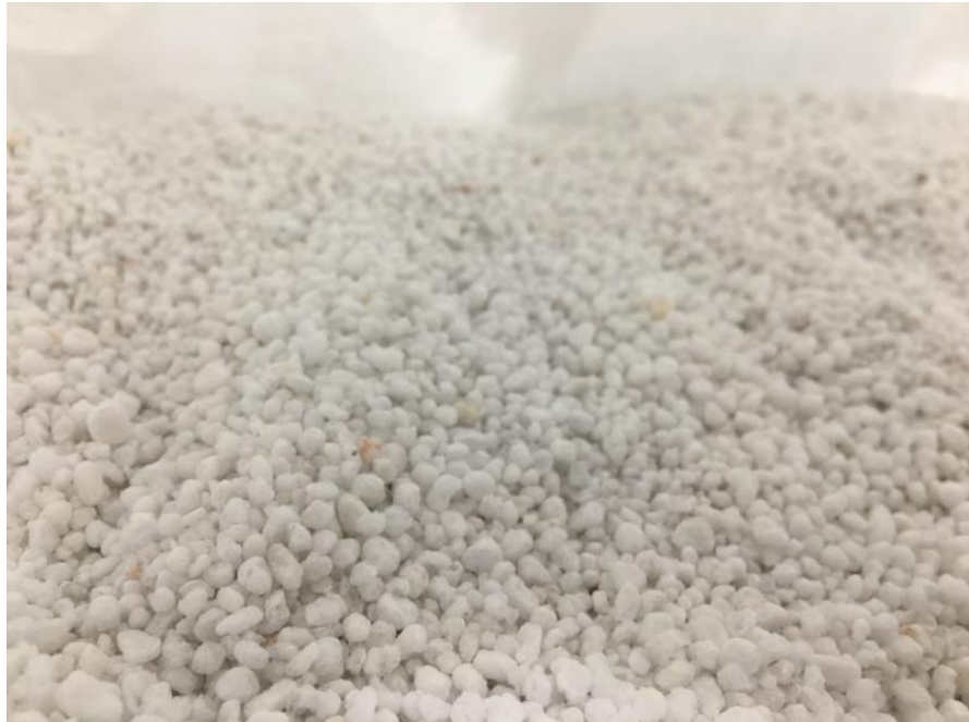
Görsel 2.7. Deneylerde kullanılan genleştirilmiş perlit
