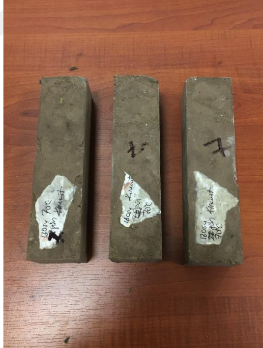
Görsel 2.18. 130 gram su ile hazırlanmış kiremit tozu agregası içeren geopolimer harç numuneleri
