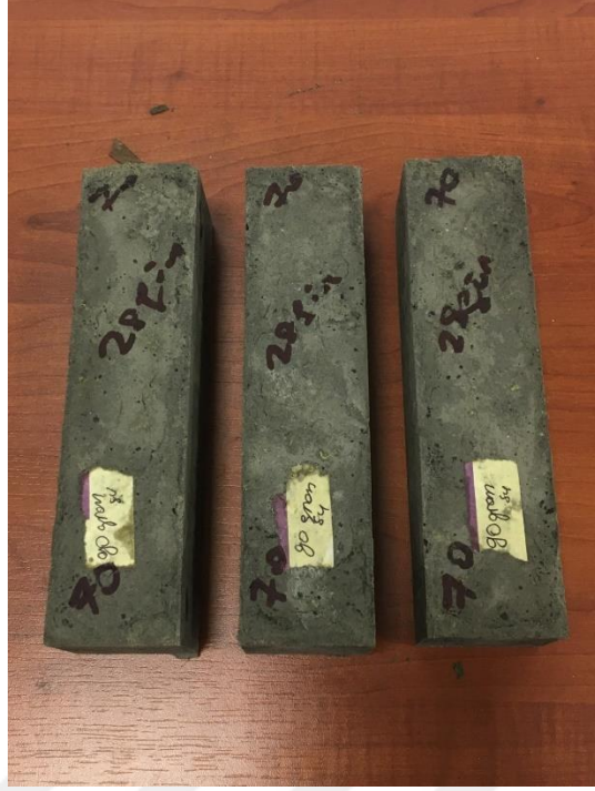
Görsel 2.13. 90 gram su ile hazırlanmış kum agregası içeren geopolimer harç numuneleri
