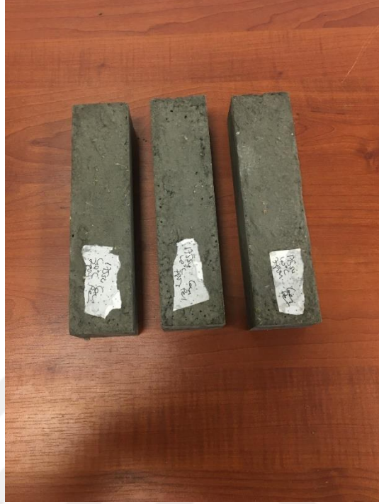
Grsel 2.19. 175 gram su ile hazırlanmıř genleřtirilmiř perit agregası ieren geopolimer har numuneleri
