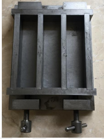
Görsel 2.9. Deneylerde kullanılan prizma kalıp
