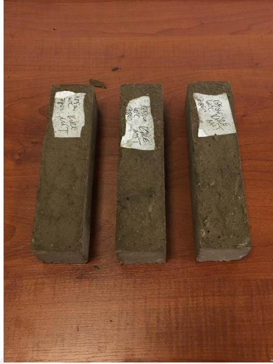
Görsel 2.17. 185 gram su ile hazırlanmış kiremit tozu agregası içeren geopolimer harç numuneleri
