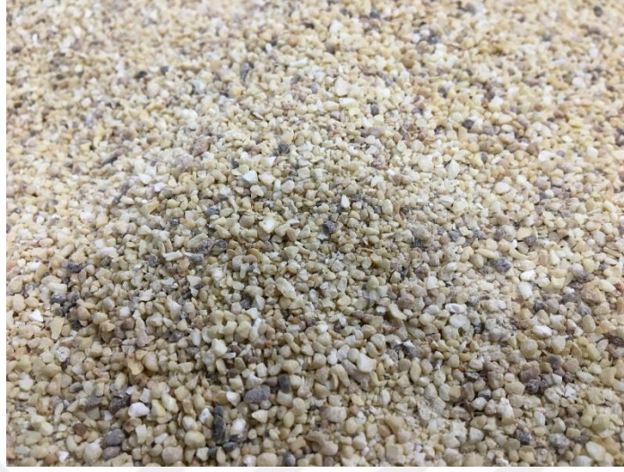
Görsel 2.5. Deneylerde kullanılan sinter manyezit
