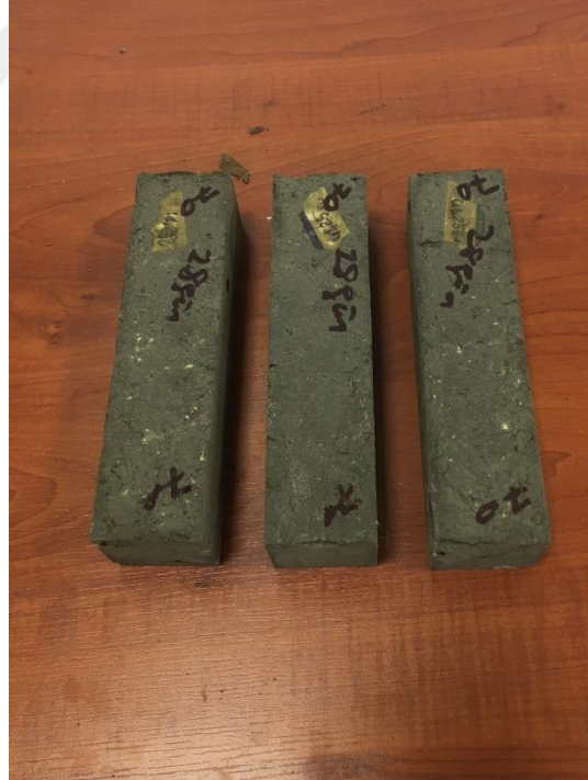
Görsel 2.14. 41,25 gram su ile hazırlanmış kum agregası içeren geopolimer harç numuneleri
