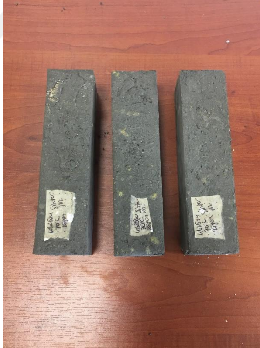
Görsel 2.16. 41,25 gram su ile hazırlanmış sinter manyezit agregası içeren geopolimer harç numuneleri
