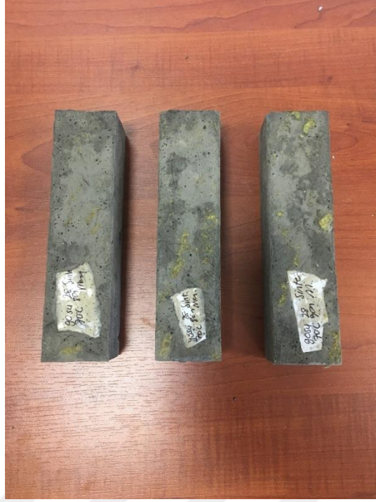
Görsel 2.15. 90 gram su ile hazırlanmış sinter manyezit agregası içeren geopolimer harç numuneleri
