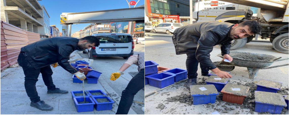
Şekil 2.1. Beton numunelerinin küplere aktarılması
