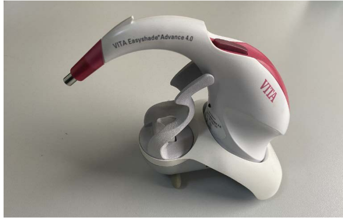
Şekil 3.8. Örneklerin renk ölçümünde kullanılan spektrofotometre
