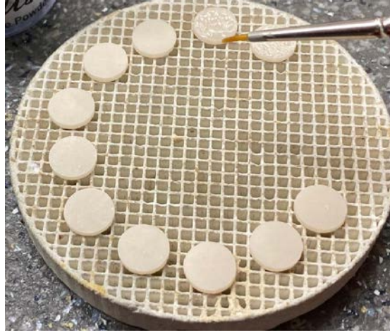
Şekil 3.6. Glaze işlemi yapılması
