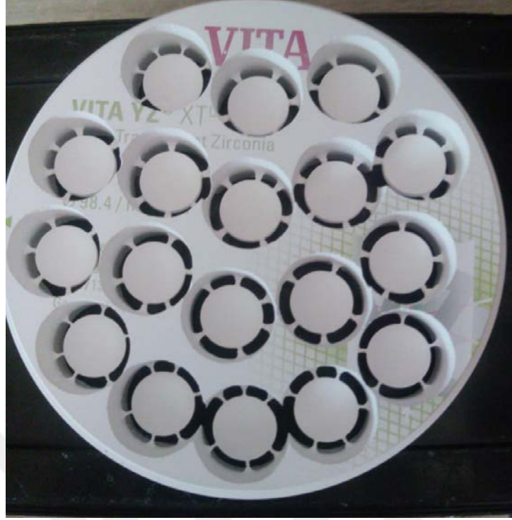
Şekil 3.2. CAD/CAM sistemi ile hazırlanan örnekler
