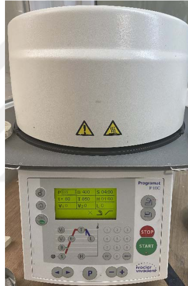
Şekil 3.7. Çalışmada kullanılan porselen fırını (Ivoclar Programat P300)
