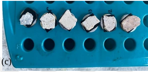
Şekil 3.9. Farklı killeri ile hazırlanan LC^3 harçlarından alınan parçaların polipropilen alkol içinde bekletilmesi (a), numunelerin kurutulması (b), numunelerin SEM/EDX deney aletine konulması (c)
