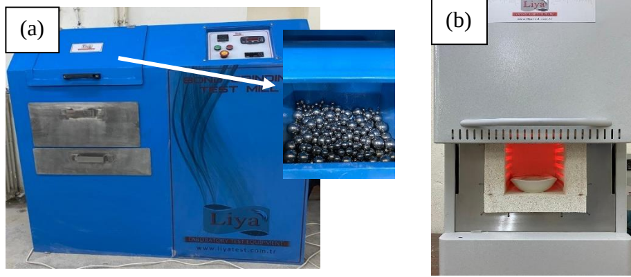
Şekil 3.6. Bond tipi bilyalı öğütücü (a) ve kül tipi laboratuvar fırını (b)
