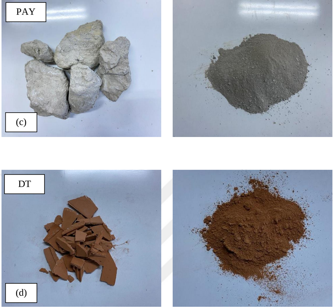
Şekil 3.2. LC 3 harçlarında kullanılan düşük kaliteli ve atık kaynaklı killerin öğütme öncesi ve öğütme sonrası görüntüleri
