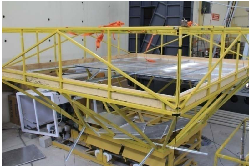
Şekil 6.21 Konfigürasyon 2-2 ATDYD D2-1 (1,44 g / 1,7 Hz) hasar görünümü
