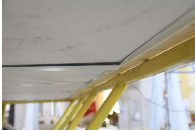
Şekil 6.20 Konfigürasyon 2-2 ATDYD D1-5 (0,96 g / 3,0 Hz) hasar görünümü
