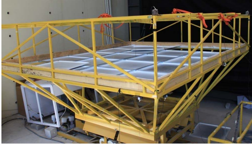
Şekil 6.23 Konfigürasyon 4 ATDYYD D3-2 (1,92 g / 2,4 Hz) hasar görünümü
