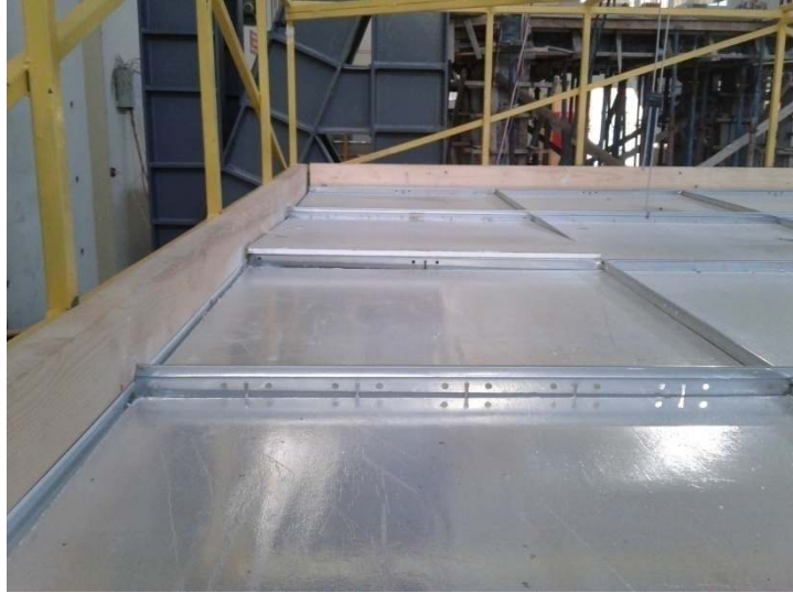
Şekil 6.11 Konfigürasyon 1 ATPYD D3-2 (1,92 g / 2,4 Hz) hasar görünümü
