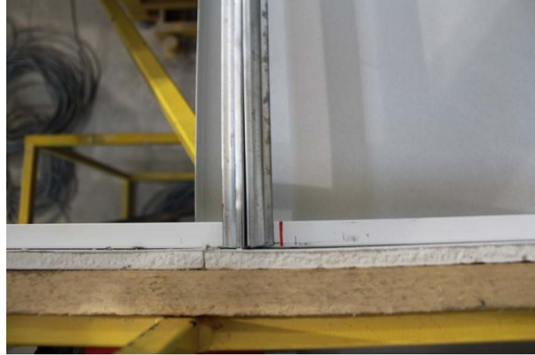
Şekil 6.27 Konfigürasyon 6 ÜTPYDD3-1(1,92 g / 2,0hz), D3-2(1,92 g / 2,4 Hz), D3-3(1,92 g / 2,7hz) hasar görünümü
