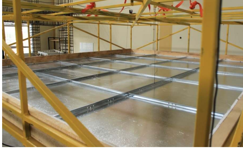
Şekil 6.2 Konfigürasyon 2-2 ana taşıyıcılı deney öncesi görünümü
