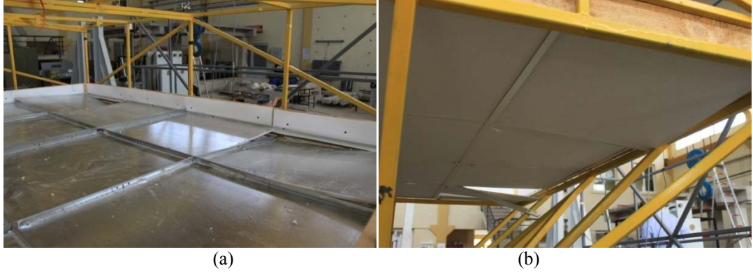
Şekil 6.17 Konfigürasyon 2-2 ATPYD (a) ve (b) D2-4 (1,44 g / 2,7 Hz), D2-5 (1,44 g / 3,0 Hz) hasar görünümü
