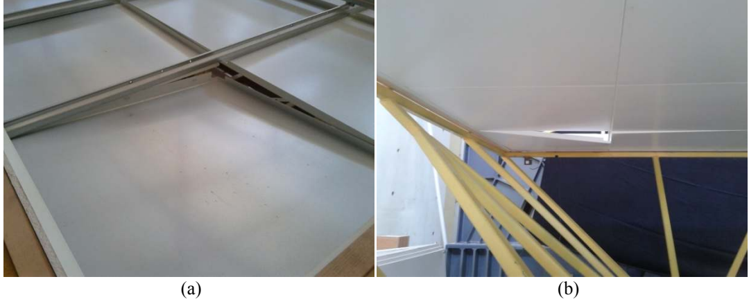
Şekil 6.24 Konfigürasyon 5 ÜTPYD (a) ve (b) D3-3 (1,92 g / 2,7 Hz) hasar görünümü
