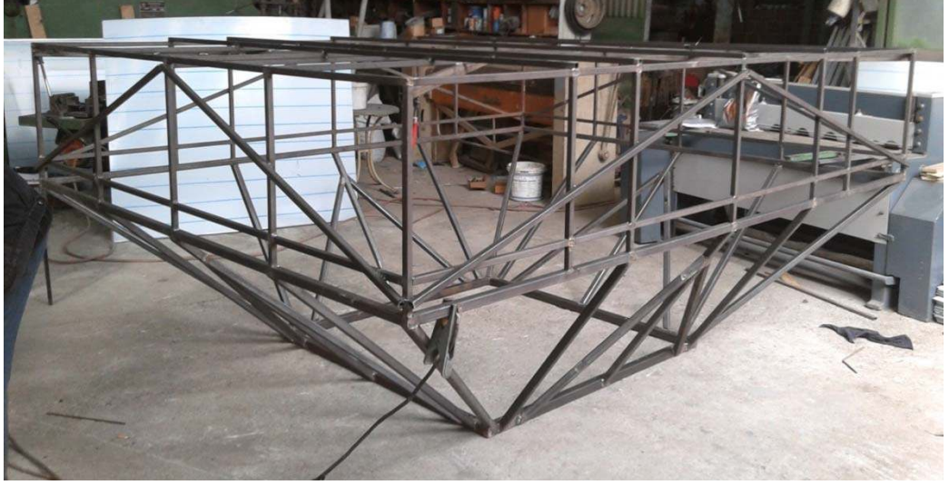
Şekil 3.10 Askı çerçevesi imalat sonrası görünümü
