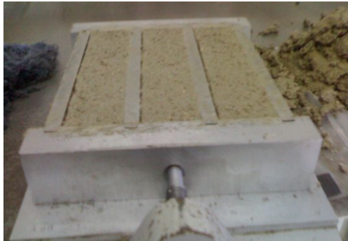
Şekil 2.5. Sıkıştırıldıktan sonra yüzeyi düzeltilmiş harç örneği
