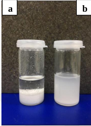
Şekil 4.5. Kloroform içerisindeki HAP partiküllerinin dispersiyonu üzerine modifikasyon işleminin etkisi; a) HAP; b) mA10-HAP
