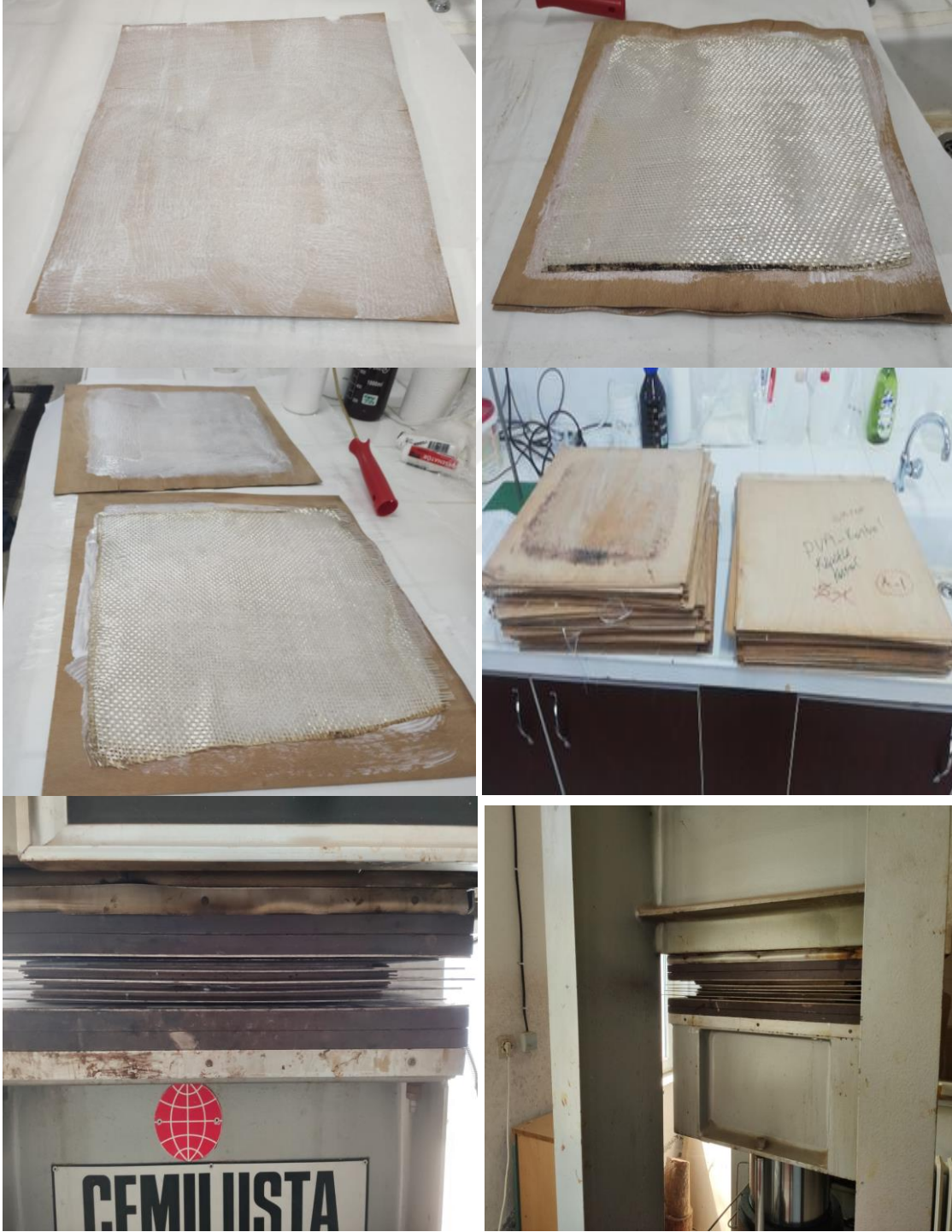
Şekil 2.3: Hazırlanan PVA tutkallarıyla kontrplakların üretilmesi ve preslenmesi
