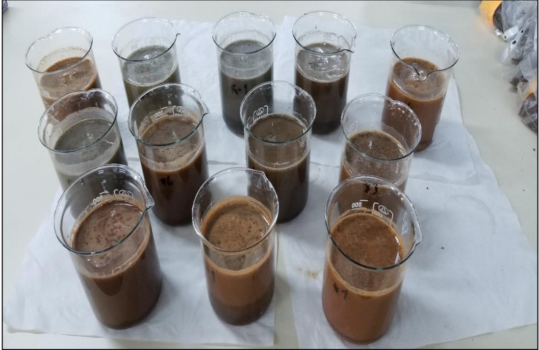
Foto 1.4: Toprak örneklerinin tane boyutu analizi için hazırlanışı (2)
