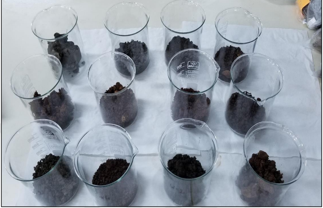
Foto 1.3: Toprak örneklerinin tane boyutu analizi hazırlanışı (1)
