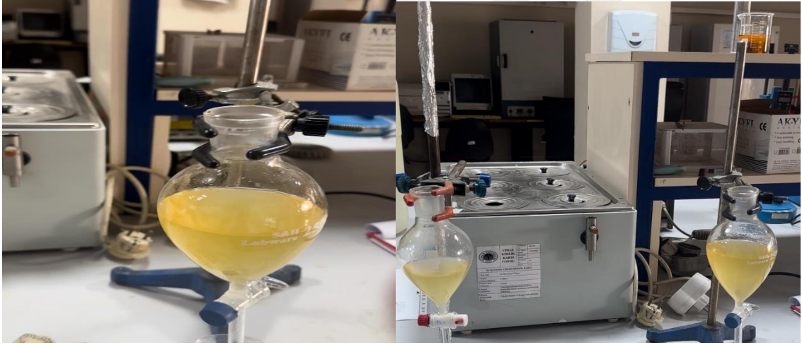
Şekil 3.3. Ayırma hunisinden gliserinin alınması (a), esterin yıkanması (b)
