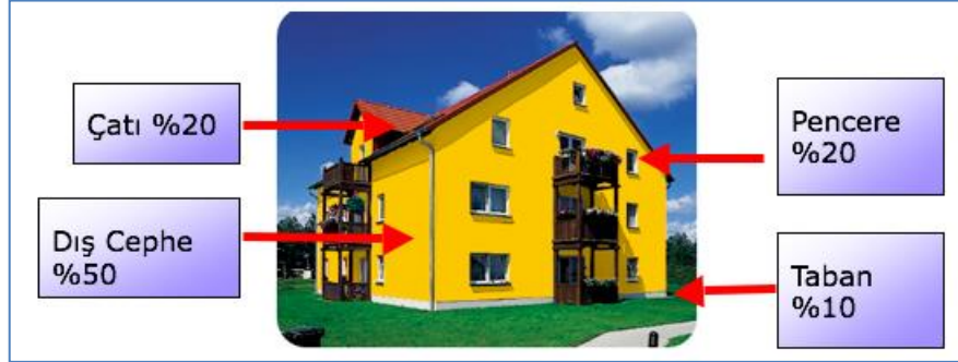
Şekil 2.4. Binalardaki ısı kaybı oranları (Altınel, 2017)
