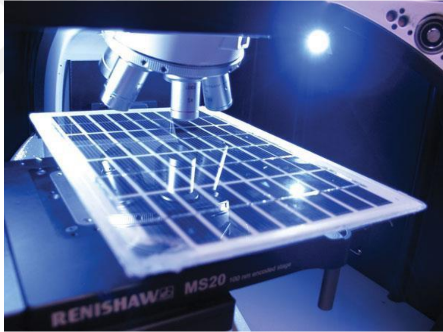
Şekil 3.3. Bir güneş pilinin Raman mikroskobu ile analiz edilmesi (Anonim 14)
