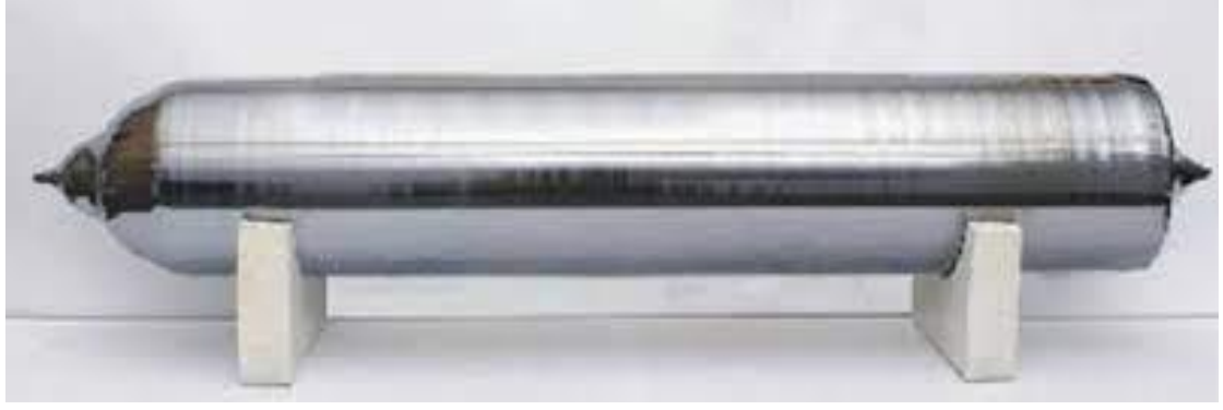
Şekil 2.6. Czochralski yöntemiyle büyütülen külçe silisyum kristali (Anonim 5)
