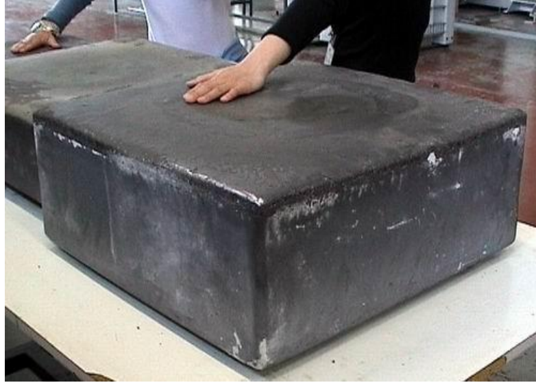
Şekil 2.7. Büyümeden sonra çok kristalli silikon levha (Yang Y. vd, 2015)
