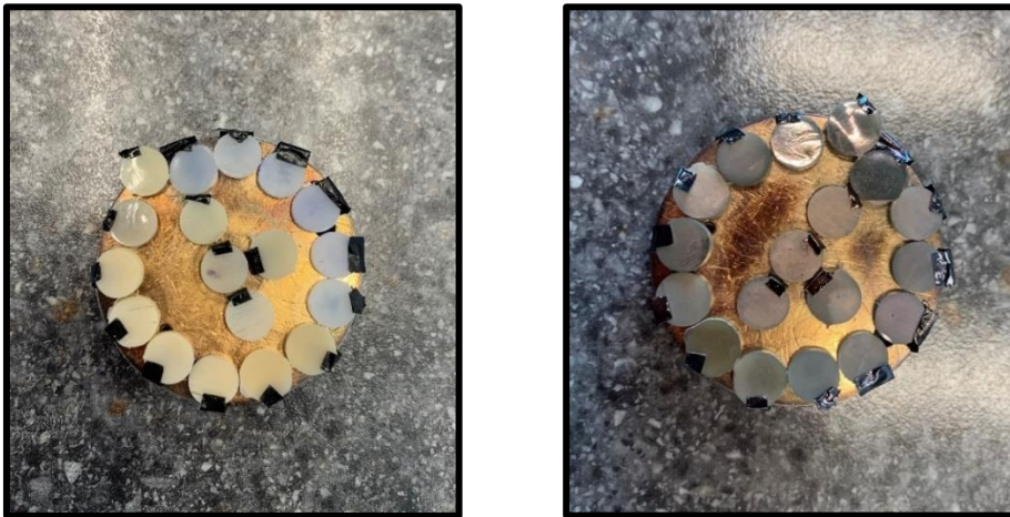
Resim 14. Altın kaplama işlemi öncesi ve sonrası
