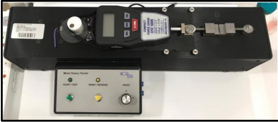
Resim 8. Mikro gerilim bağlanma dayanıklılık test cihazı
