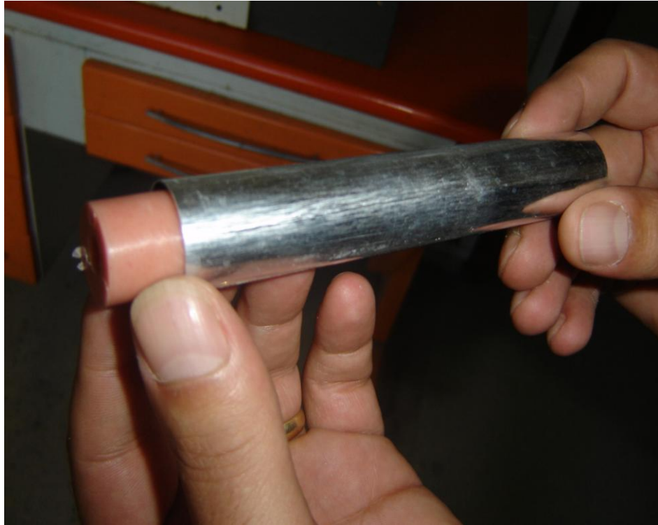
Resim 9: Asetal rezin bloklarının tüplere yerleştirilmesi
