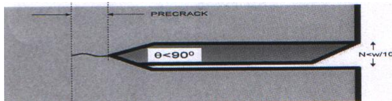
Resim 19: Ön çatlak oluşturulması
