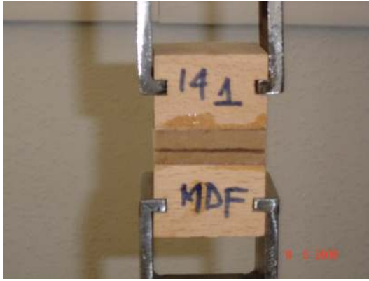
Resim 3.4. İç yapışma deney örneği ve test düzeneği
