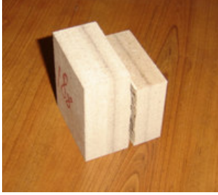
Resim 3.5. Liflere paralel yöndeki makaslama direnci deney numunesi
