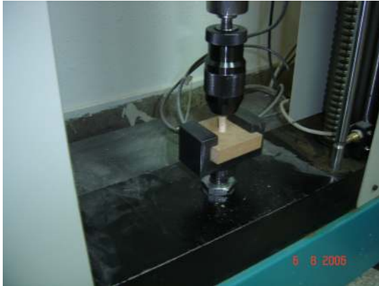
Resim 3.7. Kavela çekme direnci deney örneği ve test düzeneği
