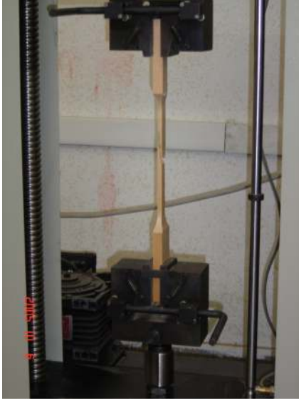
Resim 3.1. Çekme deney örneği ve test düzeneği
