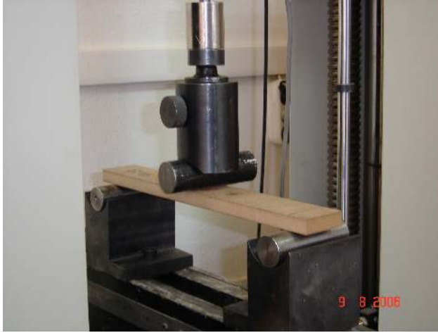
Resim 3.3. Eğilme dayanımı ve eğilmede elastikiyet modülü deney örneği resmi
