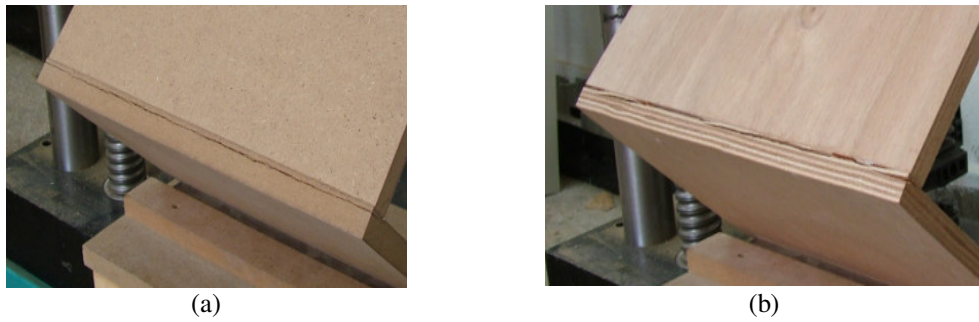
Resim 4.3. “L” tipi birleştirmelerde basınç deneyleri sonucunda gözlenen deformasyon biçimleri a) MDF b) Kontrplak
