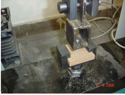
Resim 3.6. Vida çekme direnci deney örneği ve test düzeneği
