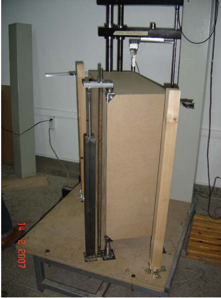
Resim 3.15. Kutu tipi mobilyalarda deney düzeneği ve yük uygulama noktası
