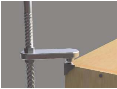
Resim 3.17. Kutu tipi mobilyalarda sınır şartları, mesnet koşulları
