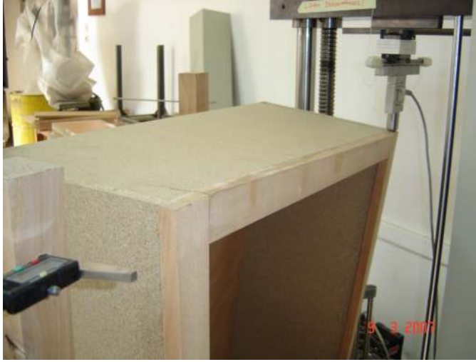
Resim 3.16. Kutu tipi mobilya testlerinde yük uygulama başlığı
