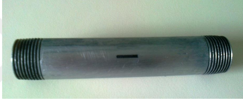
Resim 3.1 Üzerine çatlak oluşturulmuş galvanizli boru
