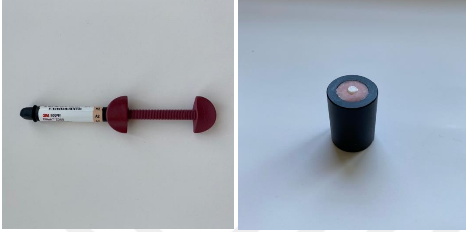
Resim 3.1. Çalışmada kullanılan resin kompozit ve hazırlanan resin kompozit örnek
