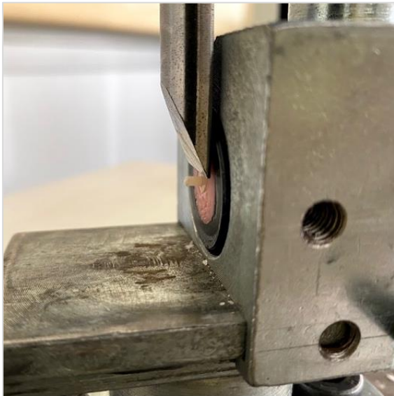
Resim 3.8. Bağlanma dayanımı testinin uygulandığı bir örnek
