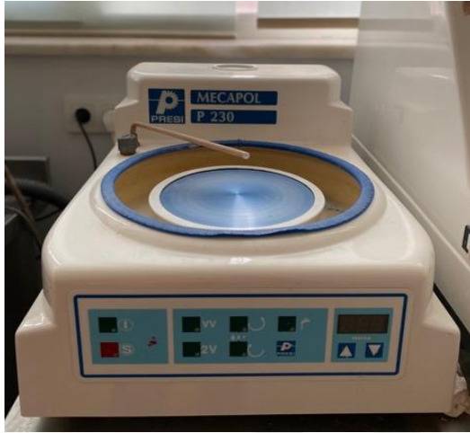
Resim 3.3. 320 gritlik silikon karbit kağıtlarla akan su altında örneklere zımpara uygulanan cihaz
