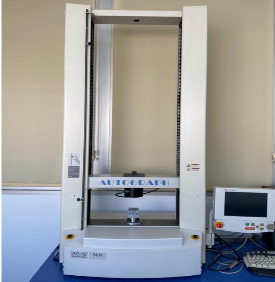
Resim 3.7. Çalışmada kullanılan mikro makaslama üniversal test cihazı
