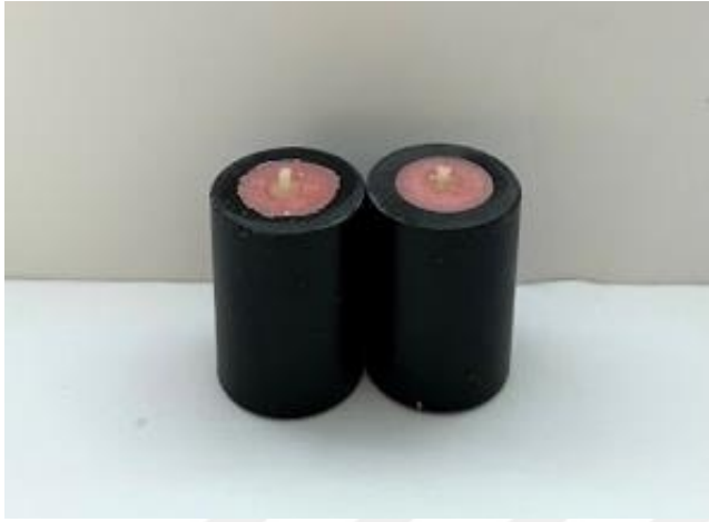
Resim 3.6. Baęlanma dayanımının ölçülmesi için hazırlanan örnekler
