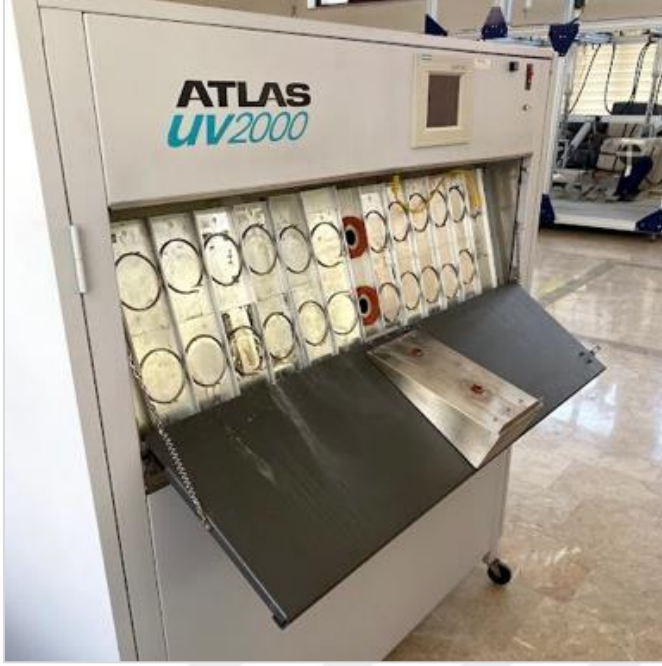
Resim 3.2. Çalışmada kullanılan yaşlandırma test cihazı
