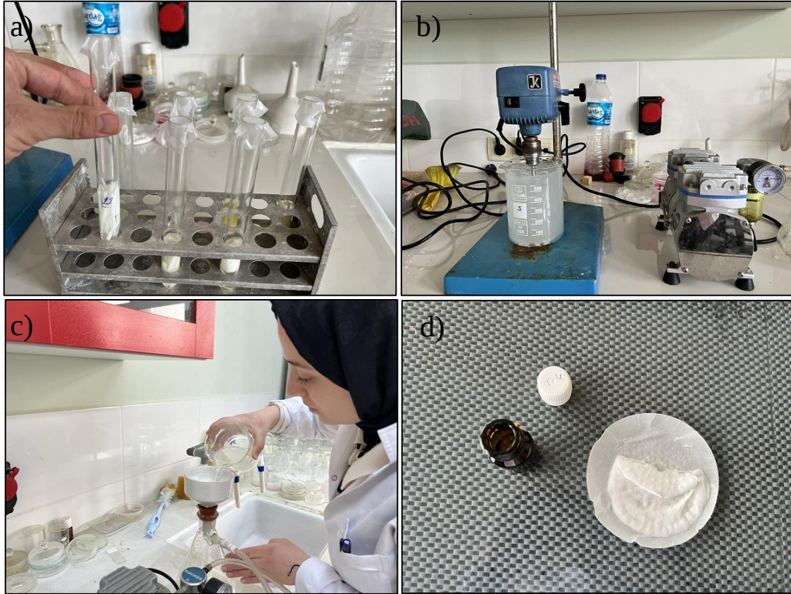
Şekil 4. Maserasyon için odun örneklerinin deney tüplerine yerleştirilmesi (a), masere olan odun örneklerinin mekanik karıştırıcı yardımıyla serbest hale getirilmesi (b), serbest hale gelen odun elemanlarının süzme işlemi (c), elde edilen numunenin gliserin içerisine alınması (d)
