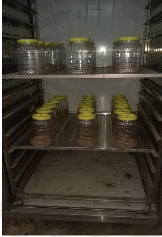
Şekil 4.5. Yaş gübre örneklerinin 30 saat süreyle 32 °C’da fermentasyona bırakılması
