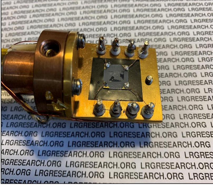
Resim 4.6. Numunenin köşelerinden alınan Van der Pauw kontak yapısı. Numune şeffaf olduğu için arkadan yapıştırma görülmektedir.
