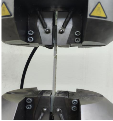
Şekil 4.5 30°/-60° KETP kompozitin çekme deneyi
