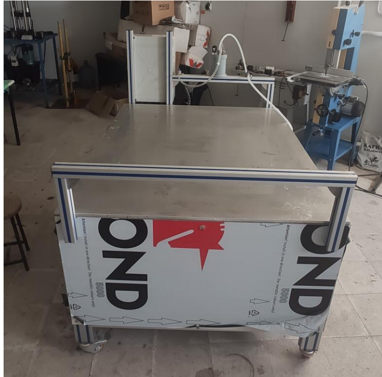
Şekil 3.3 Vakum İnfüzyon Cihazı (VIC)
