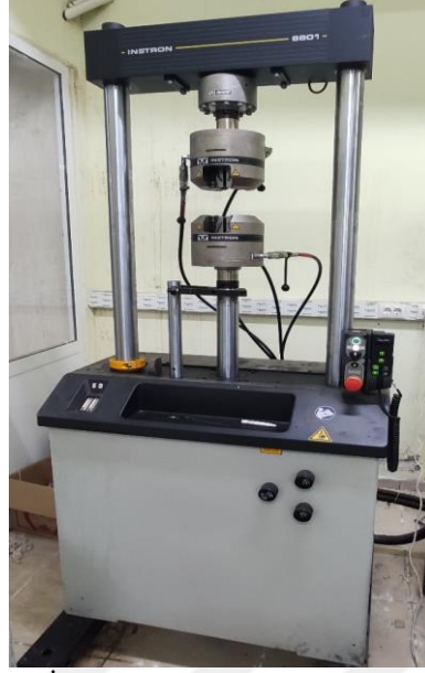
Şekil 3.5 Instron 8801 Statik Çekme Test Cihazı
