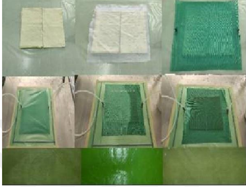
Şekil 3.4 KETP malzemenin üretim aşaması
