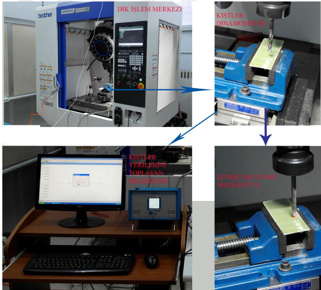
Şekil 3.7 Kesme kuvvetinin ölçülmesi
