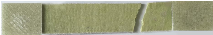
Şekil 4.6 30°/-60° KETP kompozite ait kırılmış yüzey resmi
