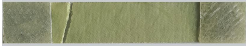
Şekil 4.3 0°/90° KETP kompozite ait kırılmış yüzey resmi
