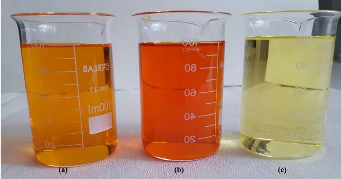
Şekil 4.24. a) Beslenen ekstrakt (E-2); b) Optimum şartlarda elde edilen retentat (PESU filtre, 1kDa, 2 bar, 4°C, 80:20 besleme oranı) ve c) Aynı şartlarda elde edilen permeat (PESU, 1kDa, 2 bar, 4°C, 80:20 besleme oranı)
