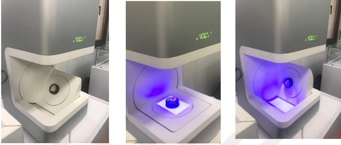
Şekil 3-15: AAdva Lab Scan ( GC Europe NV. Leuven) ile alçı modellerin taranması
