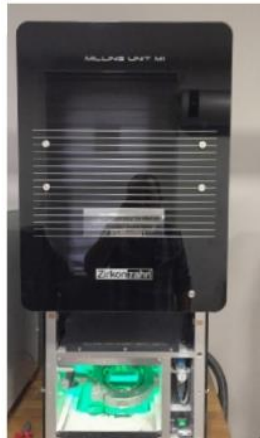
Şekil 3-21: M1 Wet Heavy Metal Milling Unit (Zirkonzahn, Gais/South Tyrol, Italy) frezeleme ünitesi
