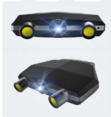
Şekil 3-31: 5 megapikselliik çift kameralı, üç boyutlu tarama başlığı
