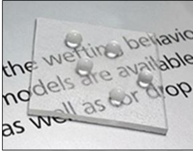
Şekil 4.13. UV kaplı süperhidrofobik cam yüzeyinde su damlacıkları
