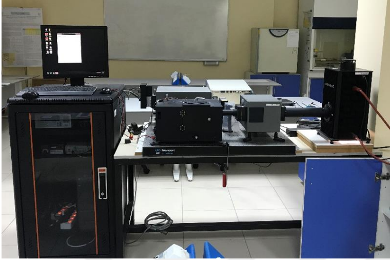
Şekil 22. DONGWOO OPTRON spektrofotometre deney düzeneği
