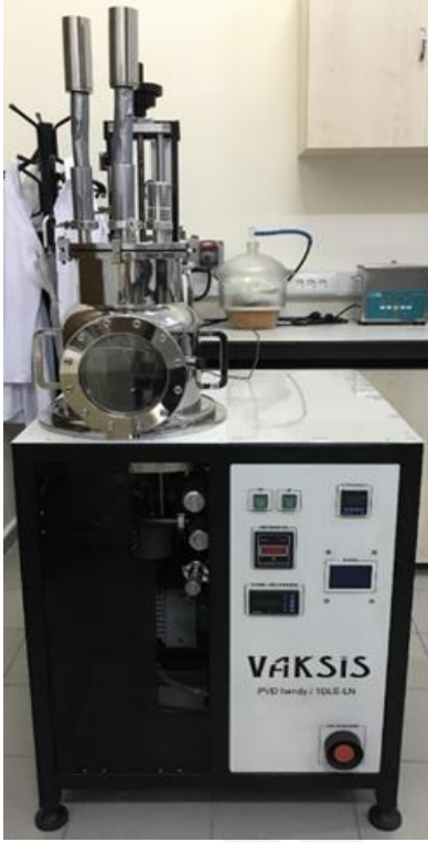
Şekil 25. Soğuk altlık yöntemi ve klasik vakum buharlaştırma yönteminde kullanılan cihaz
