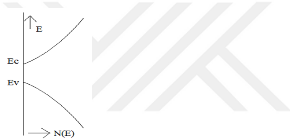
Şekil 4. Katkısız bir yarıiletkende iletkenlik ve valans bantlarında hal yoğunluğunun enerjiye bağlı değişimi
